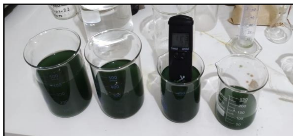
Figura 19. Toma de Temperatura, pH y turbidez
