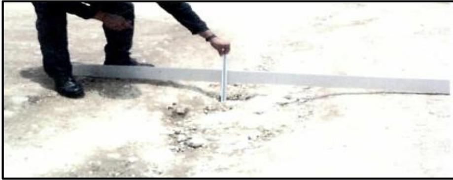
**Figura 16.** Gravedad 3: Profundidad  $\geq$  10 cm.
