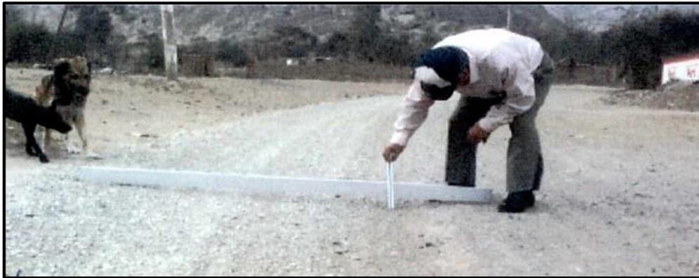
**Figura 13.** Gravedad 3: Huellas/hundimientos entre  $\geq 10$  cm.
