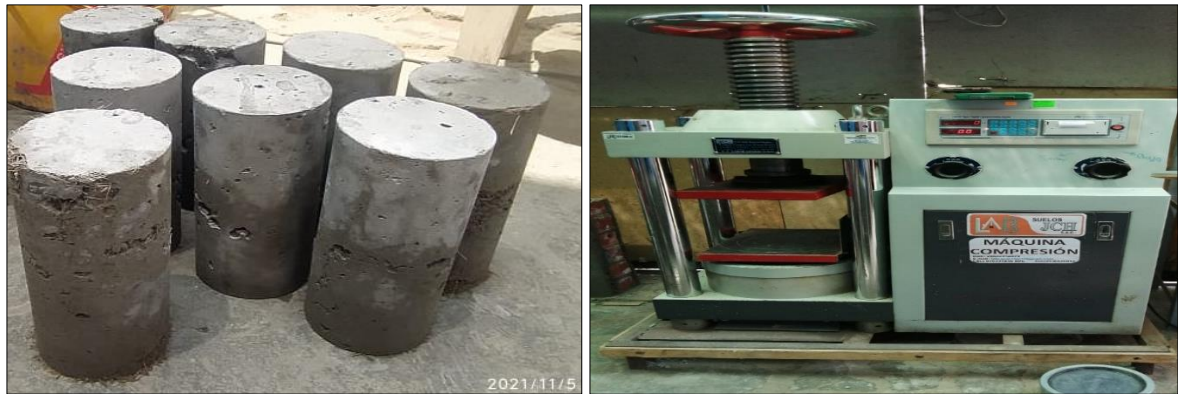
Figura 4.23 Prueba de Resistencia a la compresión
