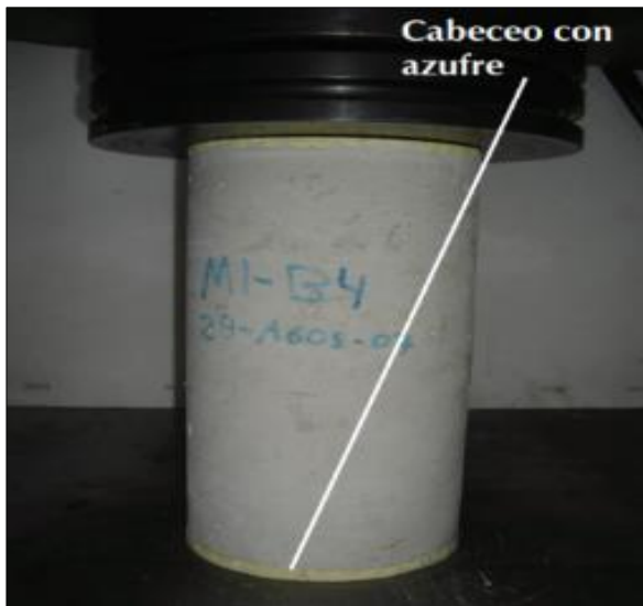
Figura 2.2 Ensayo de Resistencia a compresión Fuente: Carrillo, Alcocer & Aperador (2013)
