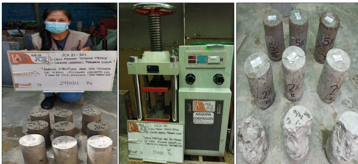
Figura 4.24 Probetas sometidas a la resistencia a la compresión (7 días)
