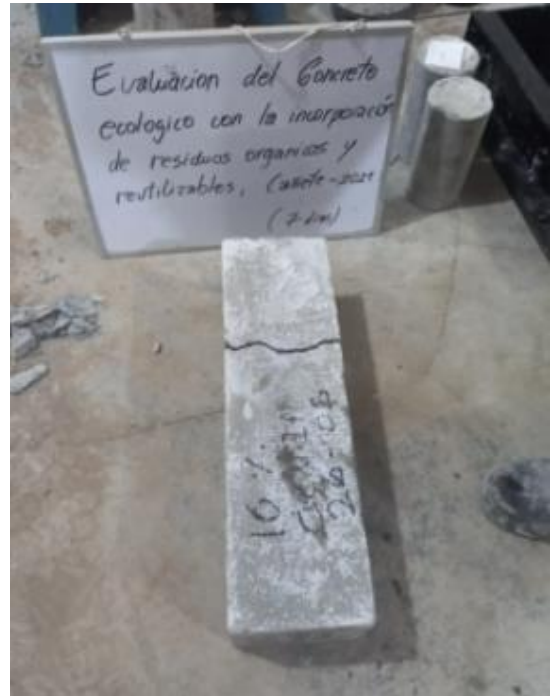
Rotura del concreto a flexión después de los 14 días
