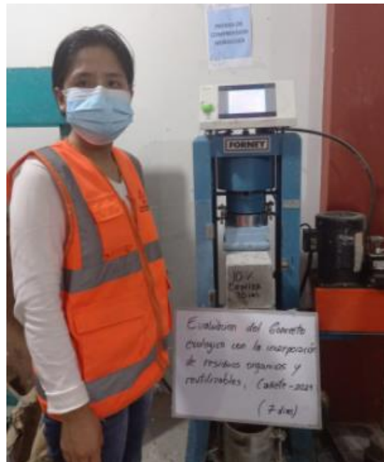
Probetas para la resistencia compresión, flexión, tracción de los 7 días
