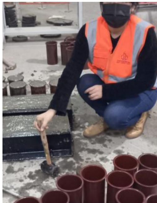
Golpes para eliminar los vacíos de aire
