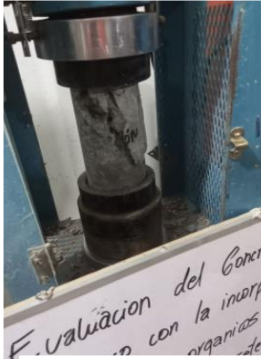
Resistencia a compresión a los 14 días Rotura del concreto
