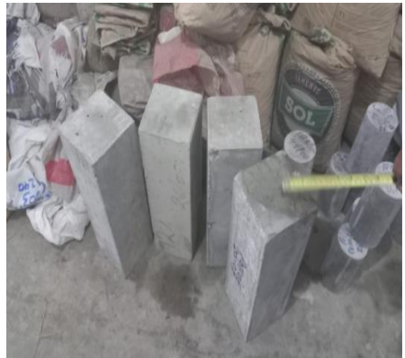
Probetas para la resistencia compresión, flexión, tracción de los 7 días
