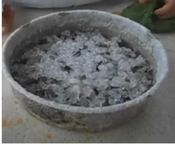
Figure 2.2 Cristalización de Agregado Mediante Sulfato de Magnesio
