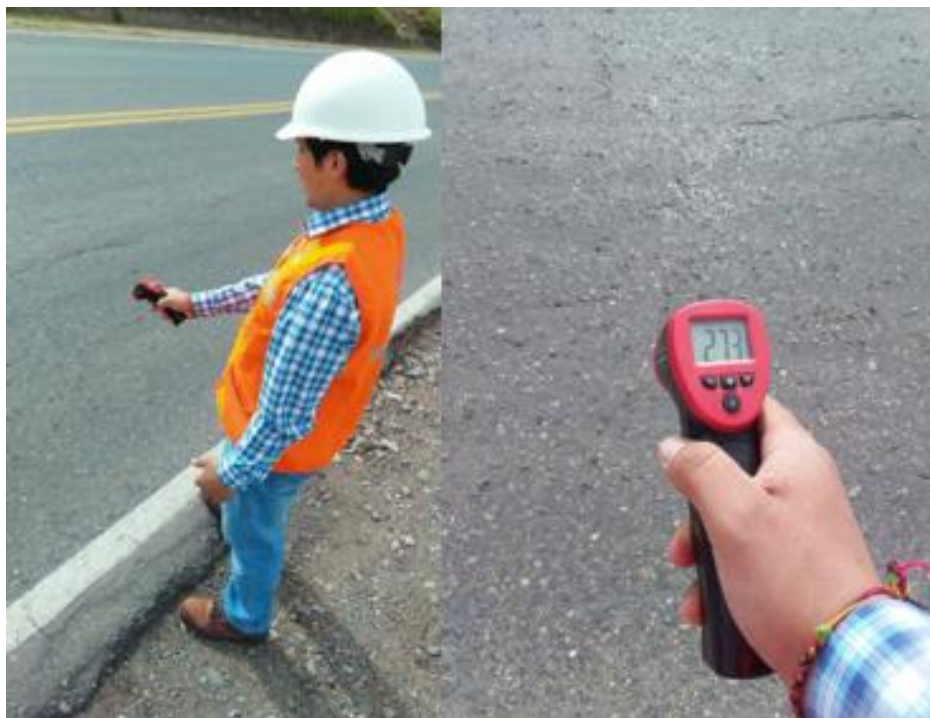
Foto N°02 Tomando Temperatura con Laser a la Superficie de la Capa Asfáltica
