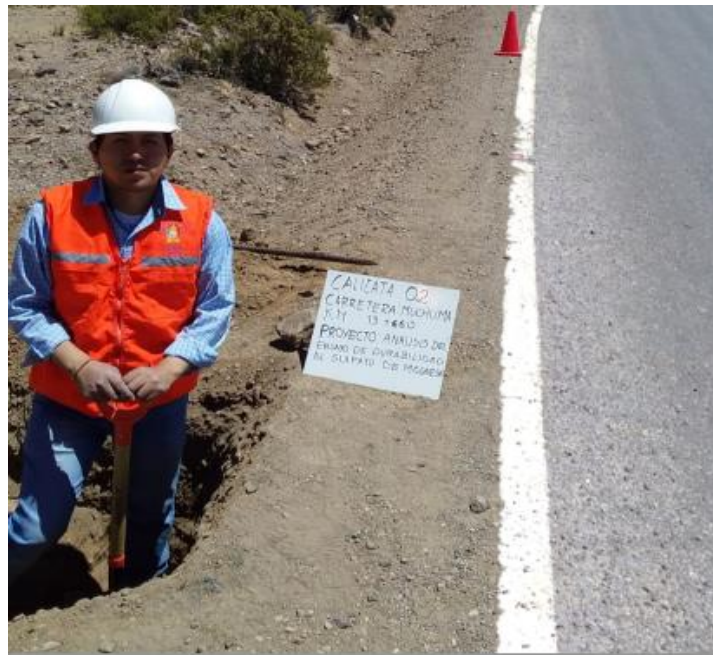
Figura 3.2 Tomando Muestra de la Calicata
