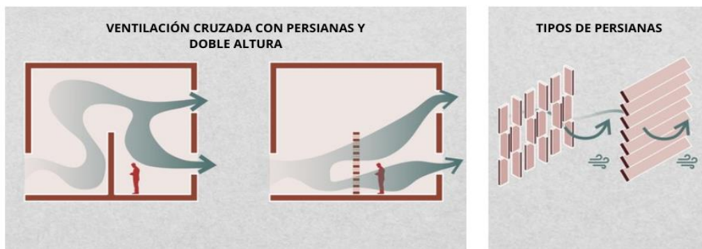
Figura 18 - Esquema de cómo utilizar la ventilación cruzada, persianas y doble altura.
