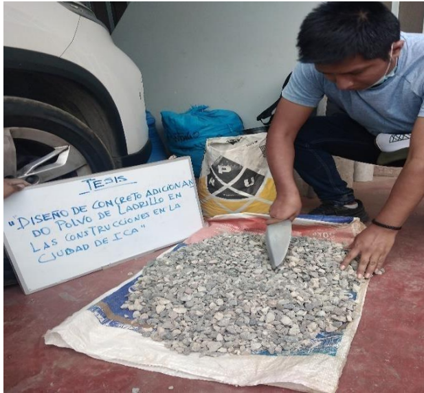
Fotografía 1. Cuarteo del agregado grueso
