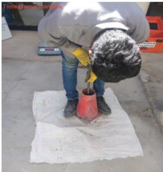
Figura 6. Ensayo de Asentamiento – Cono de Abrams
