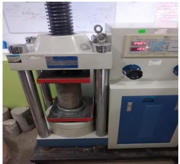
Fotografía 16. Maquina compresora de concreto
