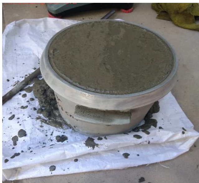
Figura 12. Mezcla de concreto en la Olla de Washington
