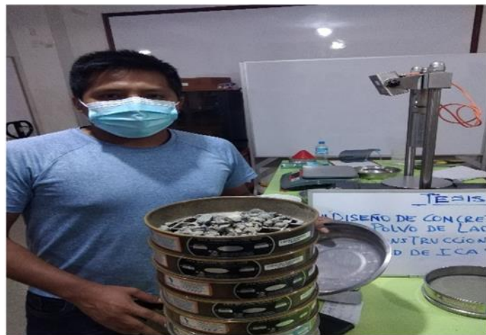
Figura 2. Realizando el tamizado del agregado grueso – Análisis granulométrico
