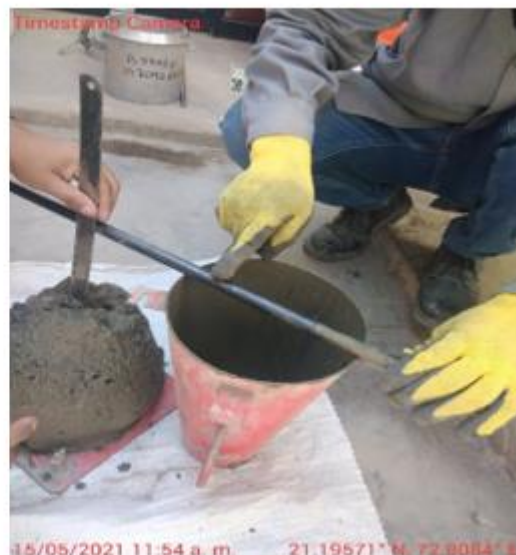
Figura 5. Medición del Slump
