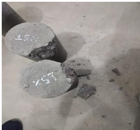
Figura 9. Rotura de probeta con remplazo de 15%
