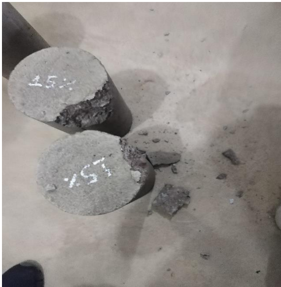
Fotografía 15. Rotura de probeta de concreto al 15%
