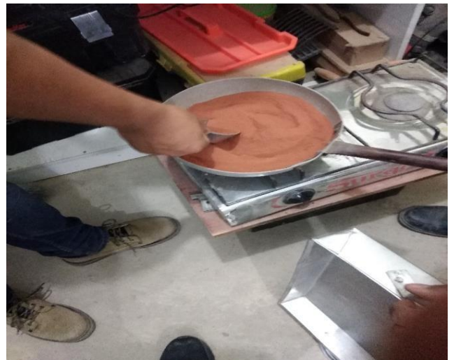
Fotografía 4. Secado del polvo de ladrillo
