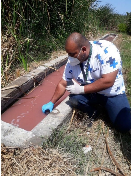
Imagen N°11: Muestreo del efluente para el ensayo del PH
