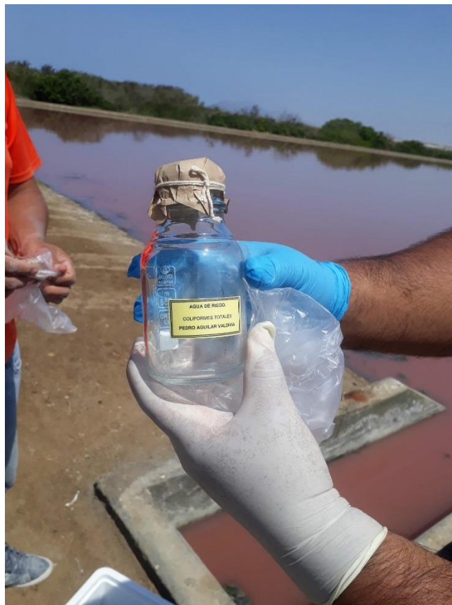
Imagen N°08: Embace para la muestra de Coliformes Fecales
