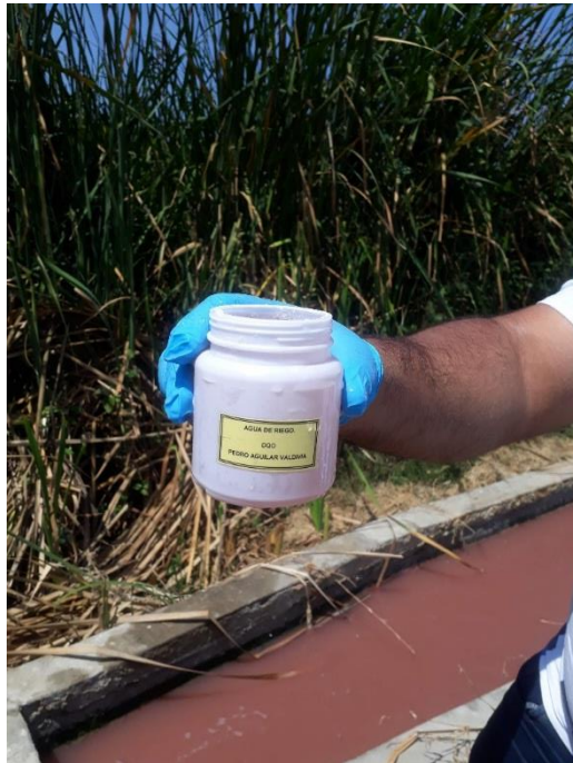
Imagen N°10: Muestreo del efluente para el ensayo del D.B.O
