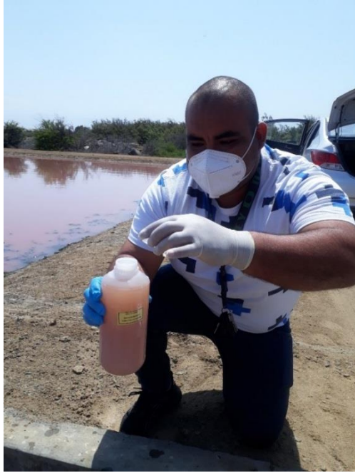
Imagen N°09: Muestreo del efluente para el ensayo del D.Q.O
