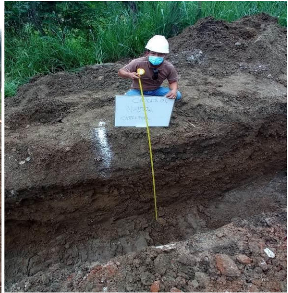
Foto N° 1: realizado de calicata con ayuda de retroexcavadora.
