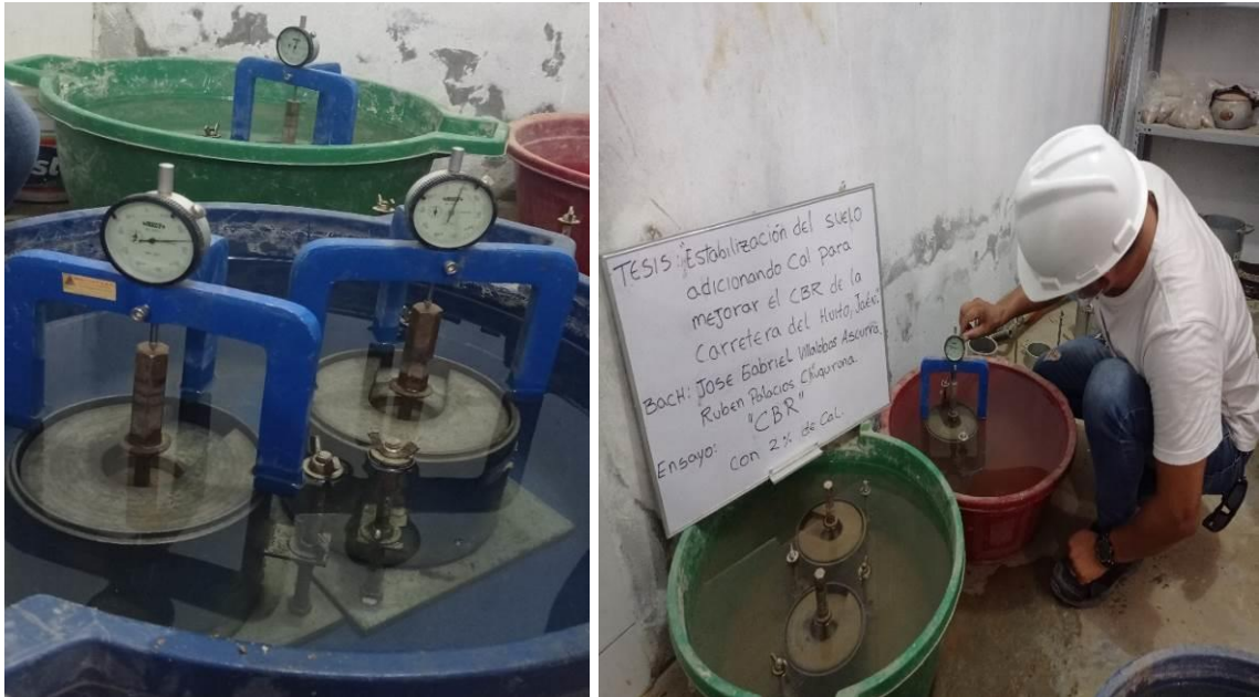
Foto N° 18: muestras de CBR sumergidas en agua por 96 horas para obtener hinchamiento.
