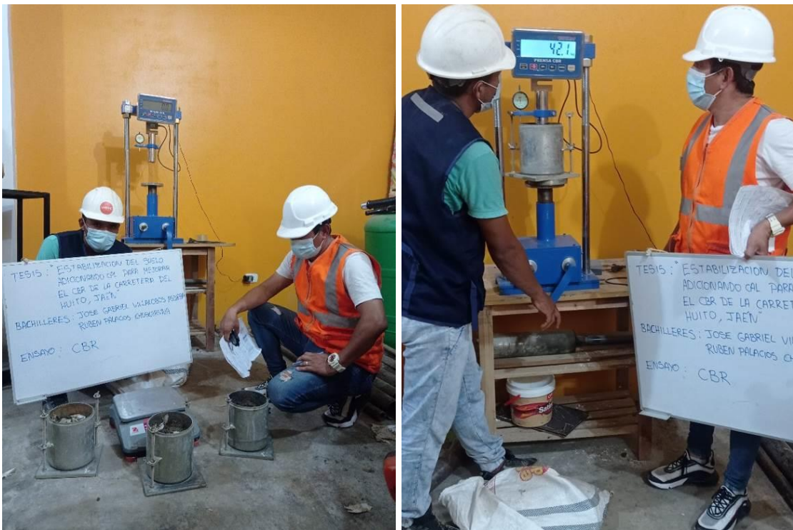
Foto N° 19: ensayo de penetración en muestras.
