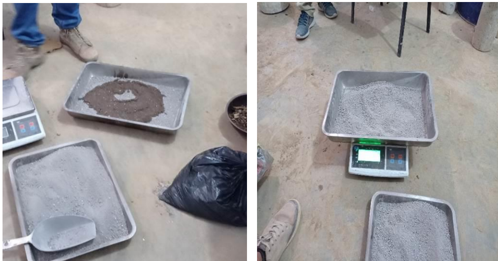
Foto N° 13: pesando y mezclado con 12%, 14% y 16% de agua en mezcla seca suelo-cal.
