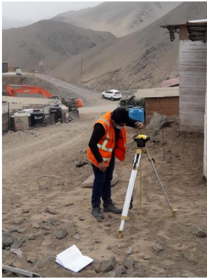
LEVANTAMIENTO TOPOGRÁFICO, TOMAS CON EL GPS EN LA CALLE 3 Y MEDICIÓN DE LA ALTURA DEL EQUIPO
