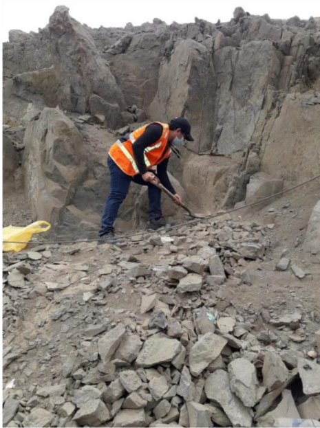
RECOLECCIÓN DE MUESTRAS DE LAS CALICATAS Y LLEVADAS AL LABORATORIO
