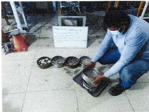
Ensayos de Clasificación en el Laboratorio "Geotecnia" de la Calicata N°01-Junta Vecinal Barrio Unido
