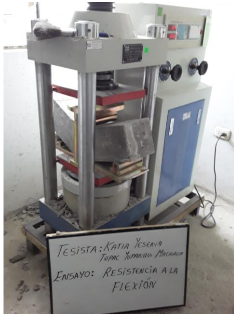
Figura 40. Vista general del proceso de ensayo de resistencia a la flexión del concreto. Fuente: Producción propia (2021).
