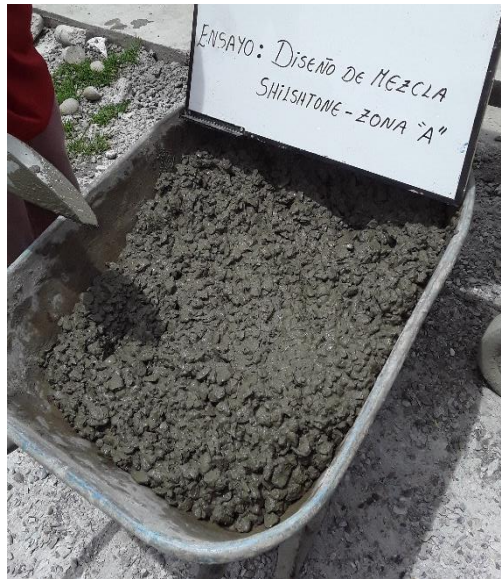
Figura 30. Vista general del concreto diseñado con la metodología Shilstone, zona A. Fuente: Producción propia (2021).
