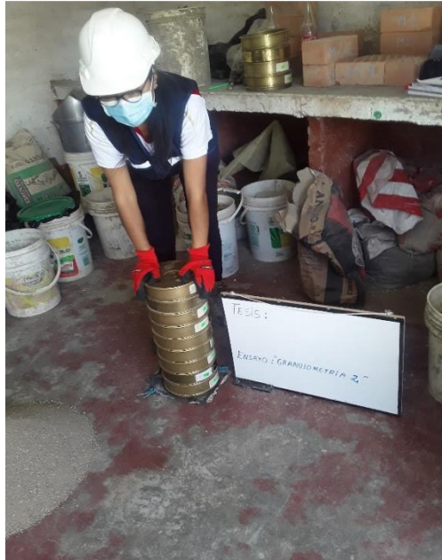
Figura 16. Proceso de tamizado del AF. Fuente: Producción propia (2021)
