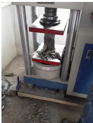
Imagen 7. Ensayo de resistencia a la compresión del concreto. Fuente: Producción propia, 2021.
