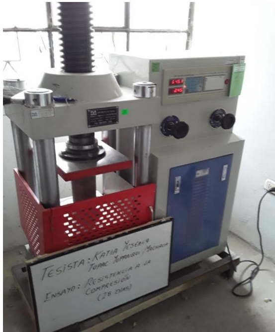
Figura 36. Vista general del proceso de ensayo de f_c . Fuente: Producción propia (2021).
