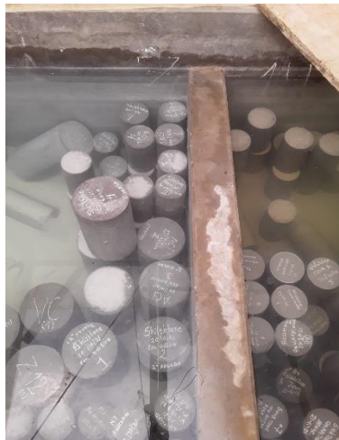
Imagen 6. Curado de testigos de concreto. Fuente: Producción propia, 2021.
