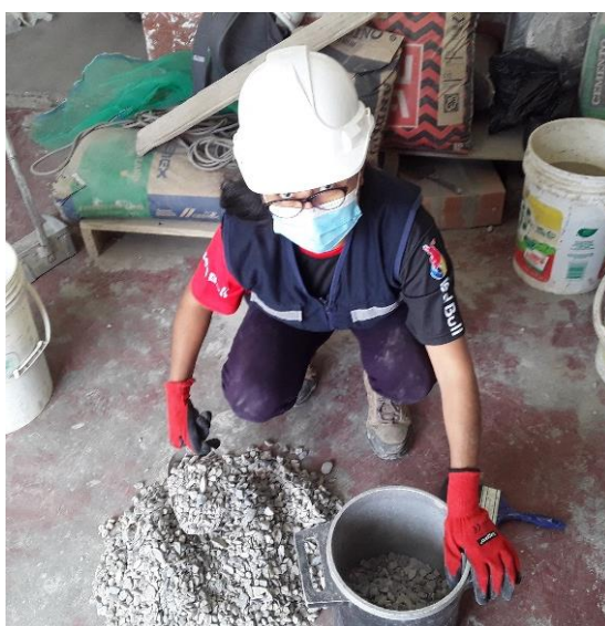
Figura 18. Ensayo de PUC del AG. Fuente: Producción propia (2021)
