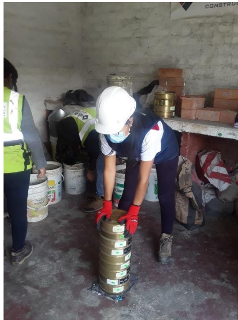
Imagen 2. Tamizado del AF. Fuente: Producción propia, 2021.
