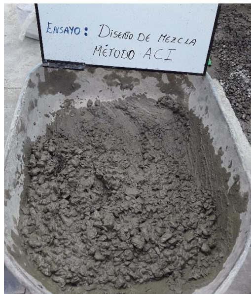
Figura 29. Vista general del concreto diseñado con la metodología ACI. Fuente: Producción propia (2021).
