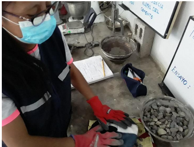
Figura 21. Ensayo de absorción del AG. Fuente: Producción propia (2021)
