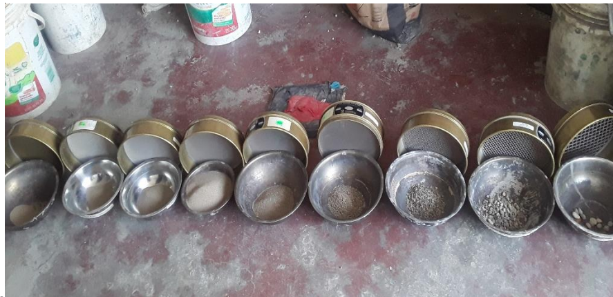
Figura 17. Granulometría del AF. Fuente: Producción propia (2021)
