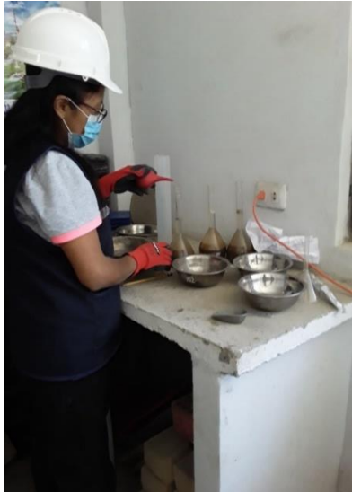
Imagen 5. Ensayo peso específico del AF. Fuente: Producción propia, 2021.
