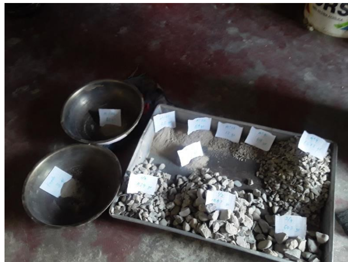
Imagen 4. Granulometría del AG. Fuente: Producción propia, 2021.
