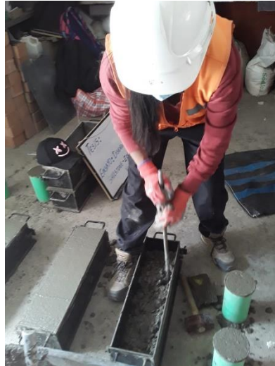
Figura 38. Proceso de elaboración de testigos de concreto en forma de vigas. Fuente: Producción propia (2021).
