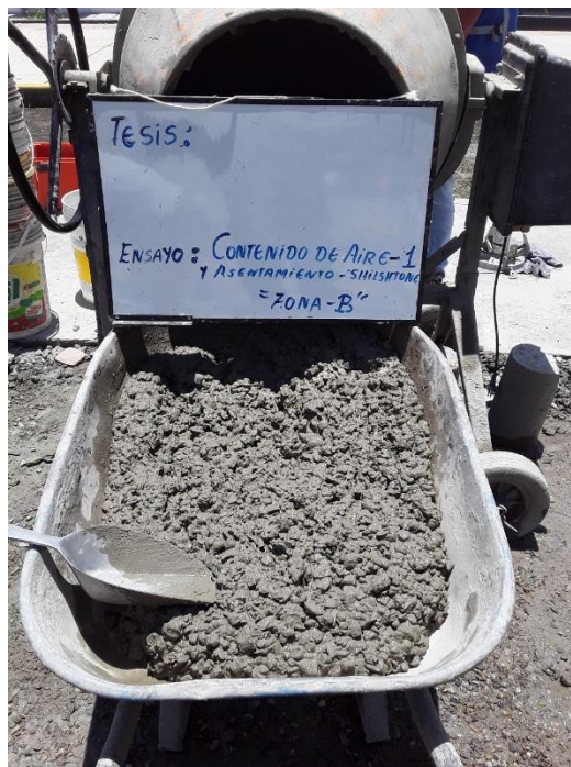
Figura 31. Vista general del concreto diseñado con la metodología Shilstone, zona B. Fuente: Producción propia (2021).
