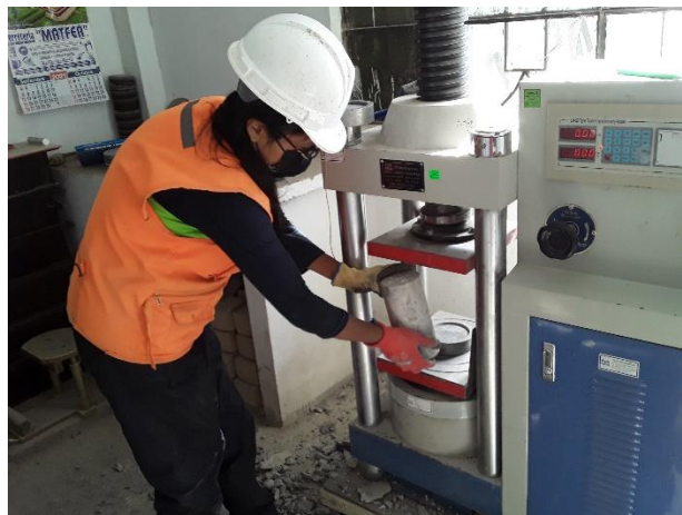
Figura 35. Proceso de colocado de testigo cilíndrico en la prensa hidráulica. Fuente: Producción propia (2021).
