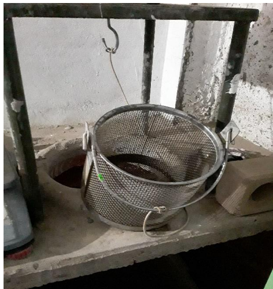
Figura 22. Ensayo de peso específico del AG. Fuente: Producción propia (2021)
