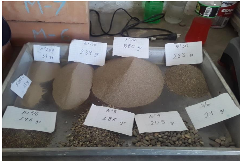
Imagen 3. Granulometría del AF. Fuente: Producción propia, 2021.
