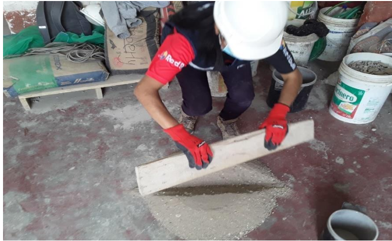
Imagen 1. Cuarteo del AF. Fuente: Producción propia, 2021.
