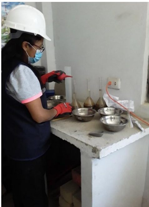
Figura 23. Ensayo peso específico del AF. Fuente: Producción propia (2021).
