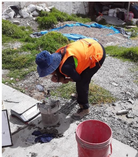
Figura 33. Control de contenido de aire del concreto. Fuente: Producción propia (2021).
