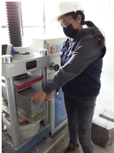
Figura 39. Proceso de colocado de viga para someterlo al ensayo de resistencia a la flexión del concreto. Fuente: Producción propia (2021).
