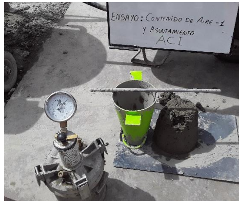
Figura 34. Vista general de los resultados obtenidos en contenido de aire y asentamiento del concreto empleando la metodología ACI. Fuente: Producción propia (2021).
