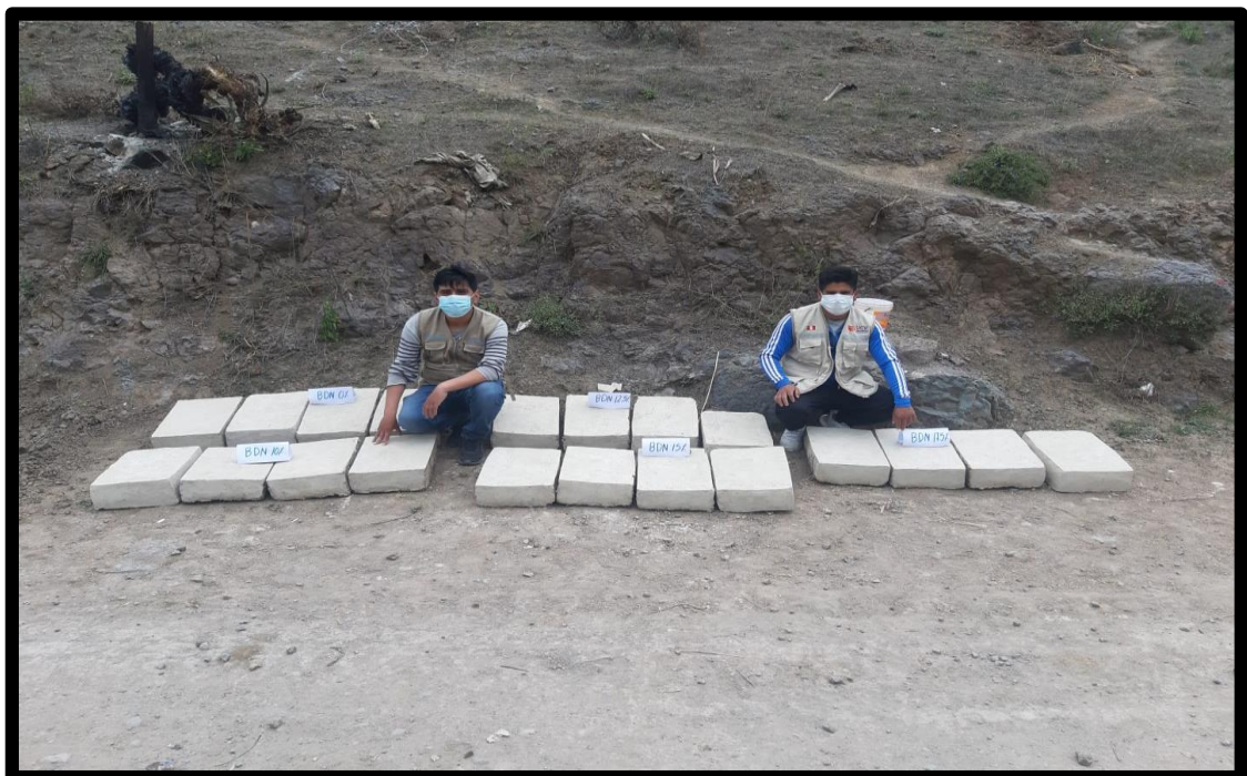
Figura 27. Pesaje de los adobes después de ser recubiertos con el mortero a base de baba de nopal
