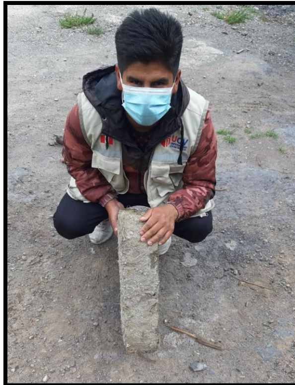
Figura 32. Se aprecia el adobe seco que se cubrió con mortero sin baba de nopal después de haber sido sumergirlo al agua.
