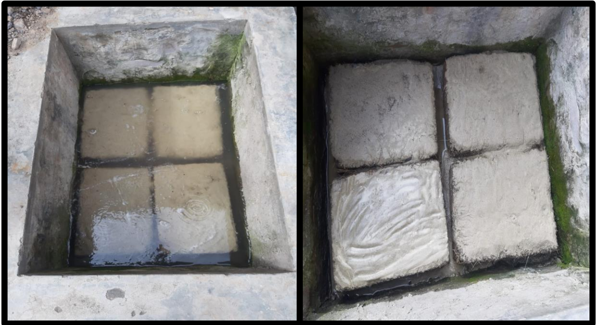
Figura 29. Adobes sumergidos en agua por un periodo de 30 minutos
