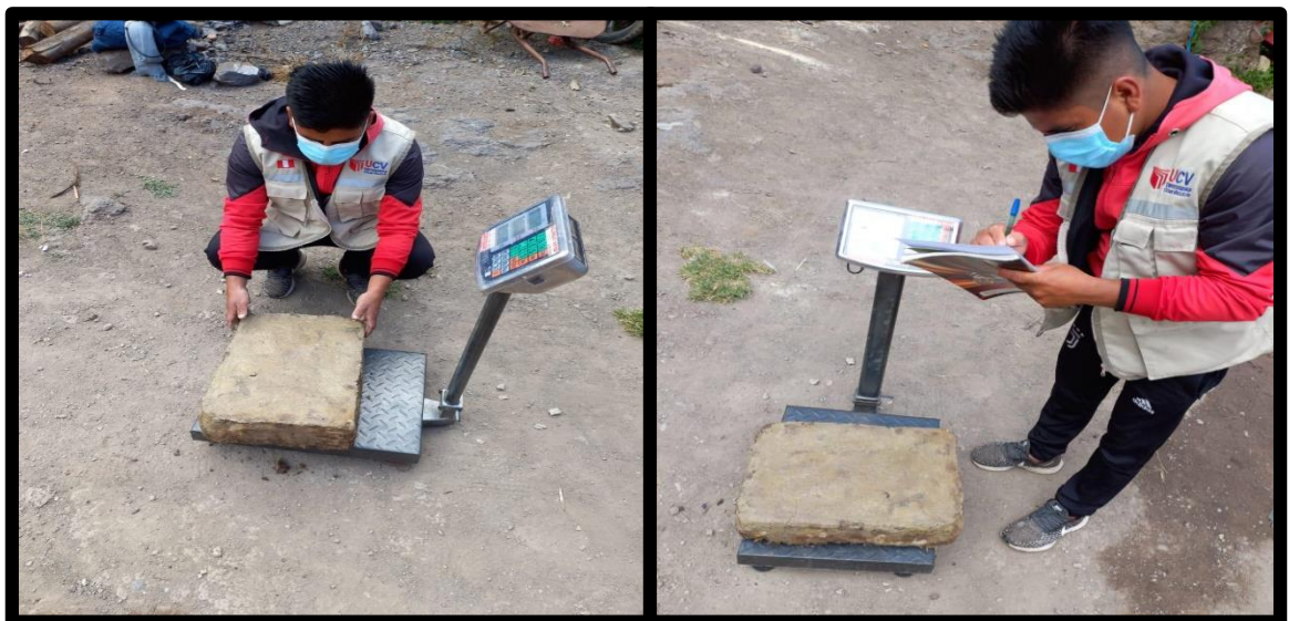
Figura 30. Pesaje y apunte de los datos obtenidos después que el adobe fue expuesto al agua.
