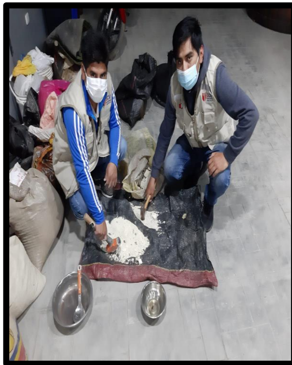
Figura 20. Trituración de la arcilla
