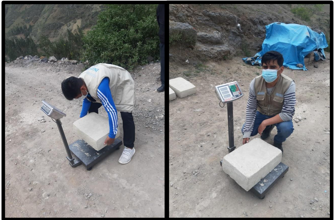
Figura 27. Pesaje de los adobes después de ser recubiertos con el mortero a base de baba de nopal
