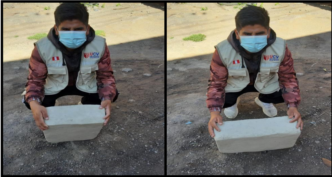
Figura 33. Se aprecia el adobe seco que se cubrió con mortero adicionando 17.5% baba de nopal después de haber sido sumergirlo al agua.
