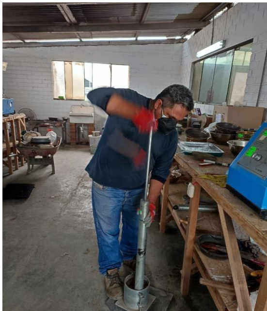
Figura 13. Compactacion del suelo Mediante el martillo manual, ensayo de proctor modificado
