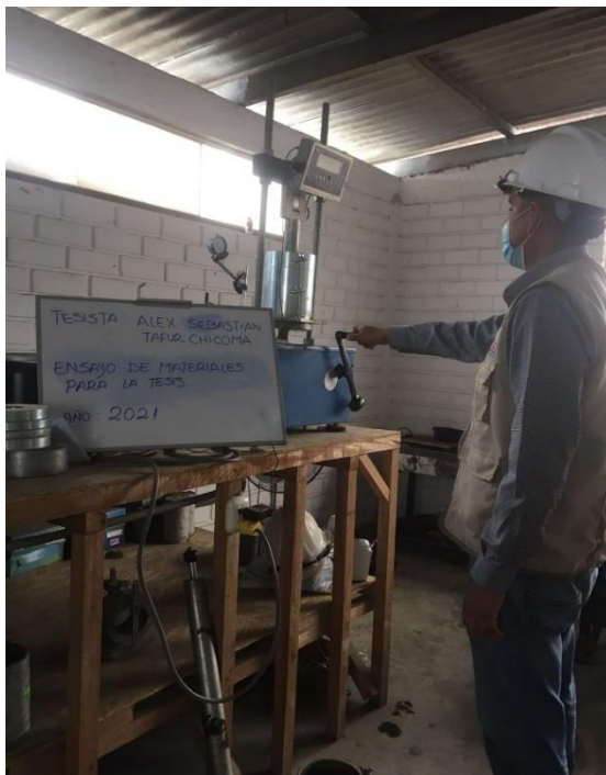
Figura 9. Prensa CBR, para la medición de la capacidad de soporte de la muestra
