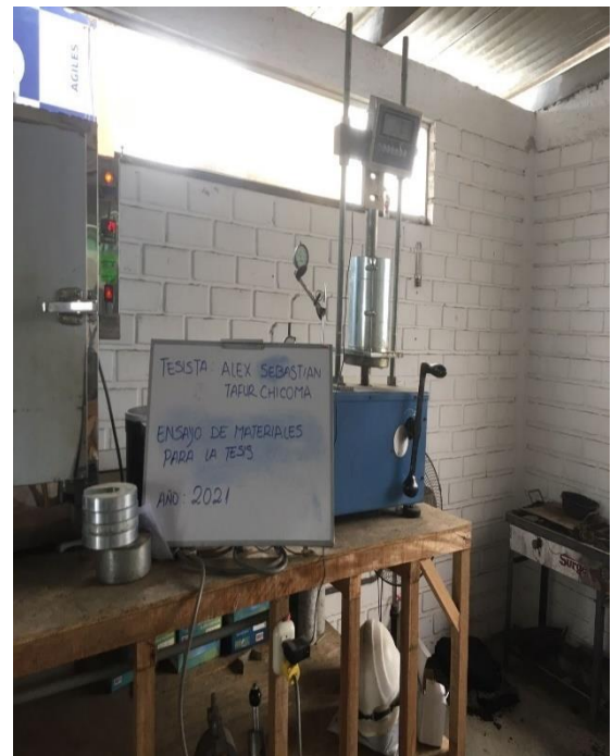
Figura 9. Prensa CBR, para la medición de la capacidad de soporte de la muestra
