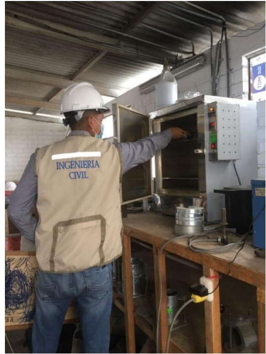
Figura 8. Horno Eléctrico, para el secado de la muestra del suelo
