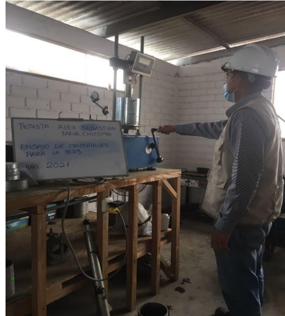
Figura 20. Análisis de muestra de suelo con prensa CBR
