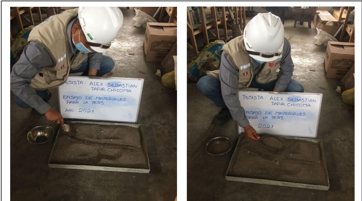
Figura 10. Cuarteo en proporciones de tamaños adecuados para obtener la muestra
