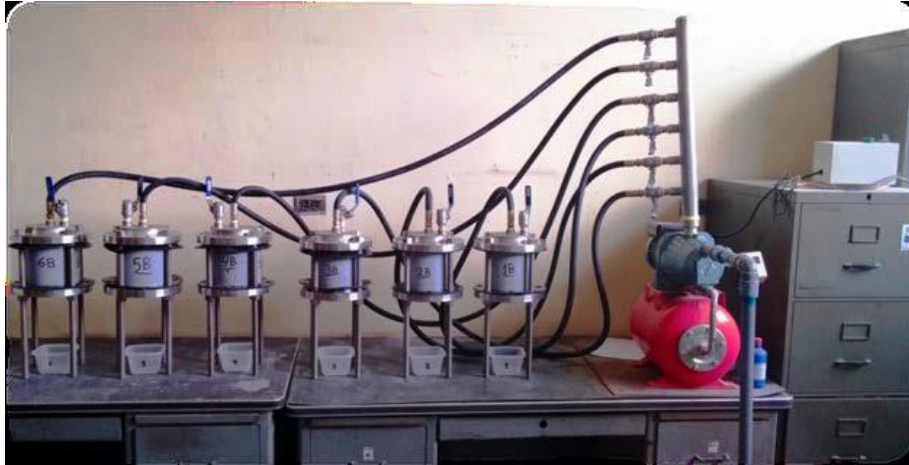
Figura 5: Método de presión para medir la permeabilidad en el concreto
