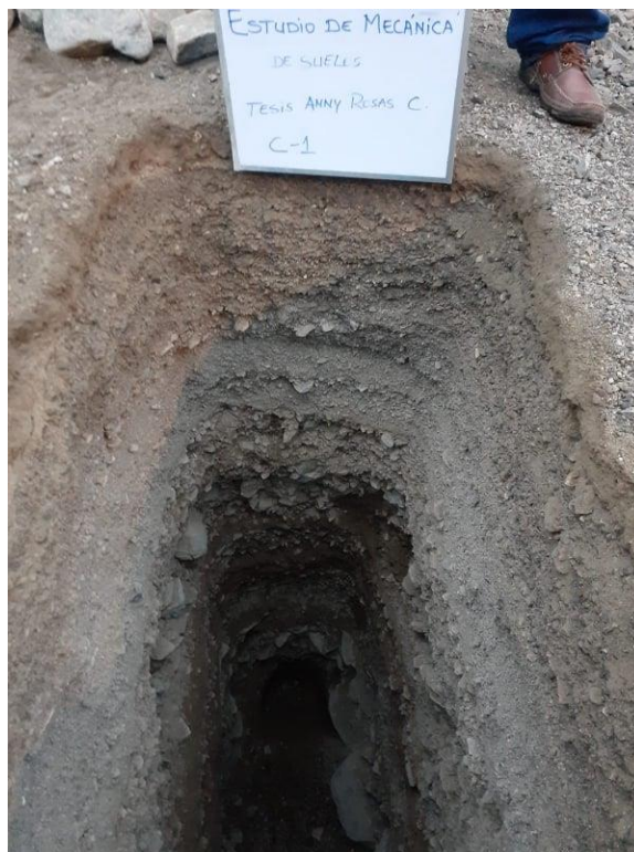
Imagen N° 1: Calicata – 1 con 3m. de profundidad.
