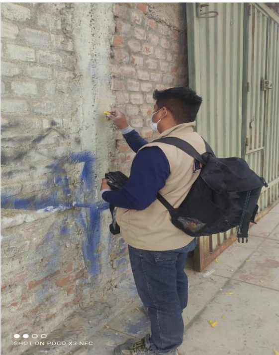
Figura 11: Evidencias del procedimiento de evaluación de los elementos estructurales con ensayo de esclerometría (vivienda 4).
