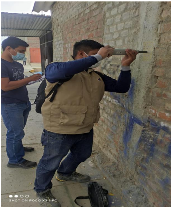
Figura 11: Evidencias del procedimiento de evaluación de los elementos estructurales con ensayo de esclerometría (vivienda 4).
