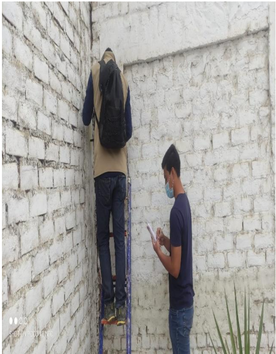
Figura 10: Evidencias del procedimiento de evaluación de los elementos estructurales con ensayo de esclerometría (vivienda 3).
