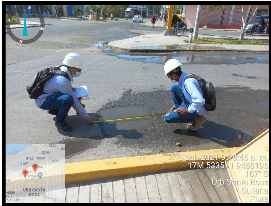
FOTO 12 Medición y clasificación de la falla encontrada en la superficie del pavimento
