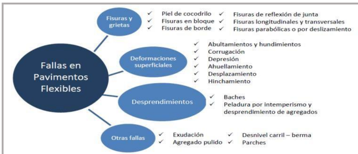
Figura 1. Resumen de fallas en los pavimentos flexibles
