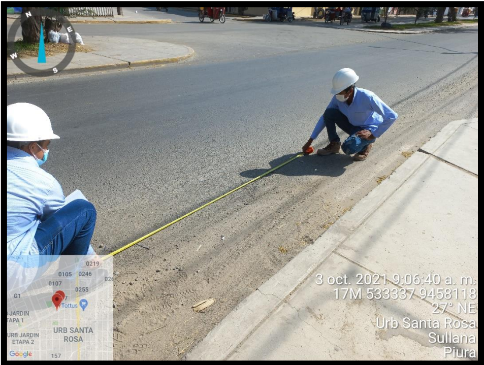
FOTO 11 Medición y clasificación de la falla encontrada en la superficie del pavimento
