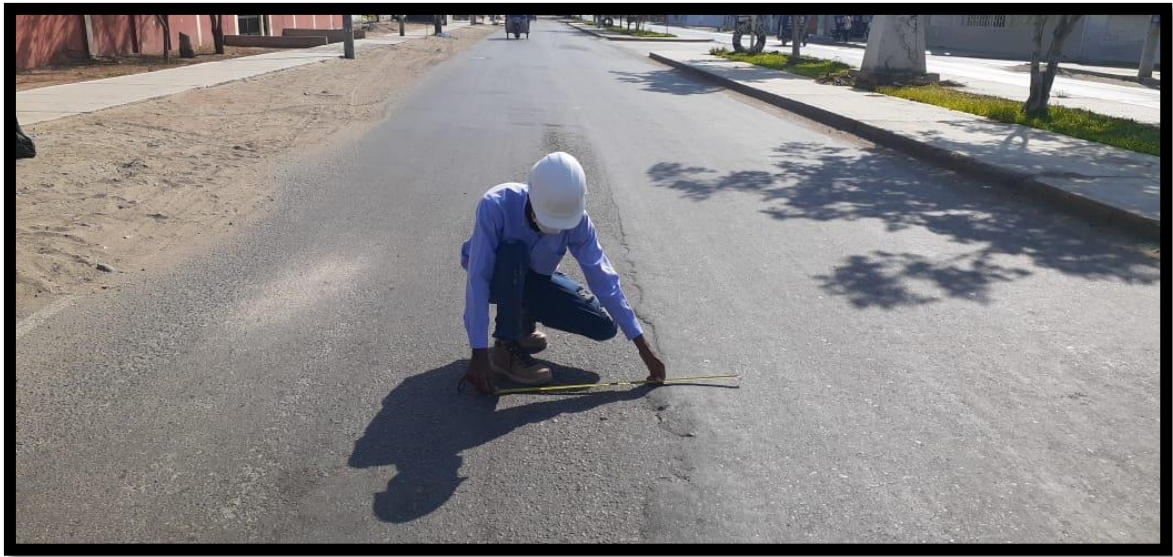
FOTO 07 Medición y clasificación de la falla encontrada en la superficie del pavimento
