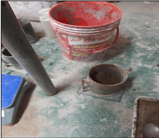
Fotografía 7. Ensayo de CBR
