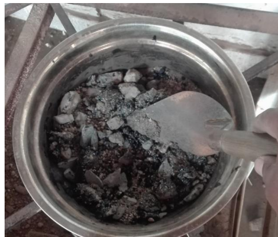
Fotografía 24. Mezcla de los agregados
