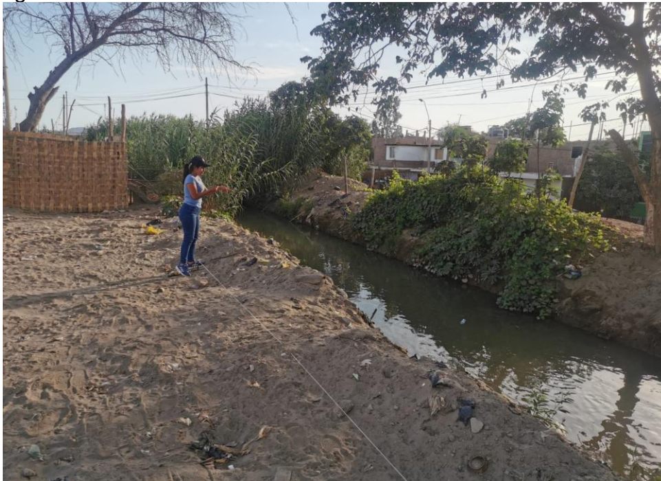
figura 10. Obtención de la velocidad media – Método del flotador
