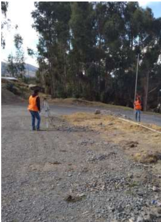
Estacionamiento de nivel óptico y mira
