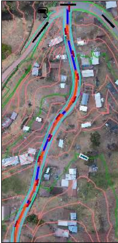
Figura 17. Plano en planta alineamiento horizontal – topografía convencional
