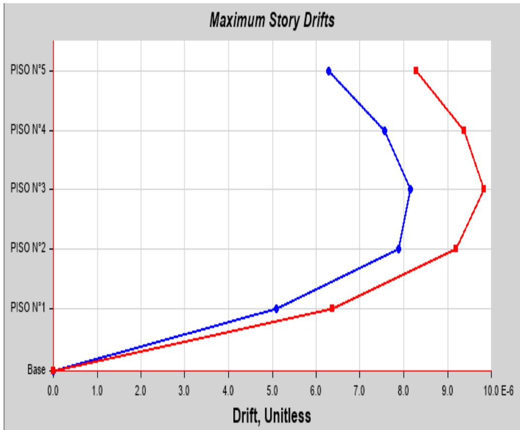
Figura 23: Distorsiones en dirección X-Y de espesor 12 cm
