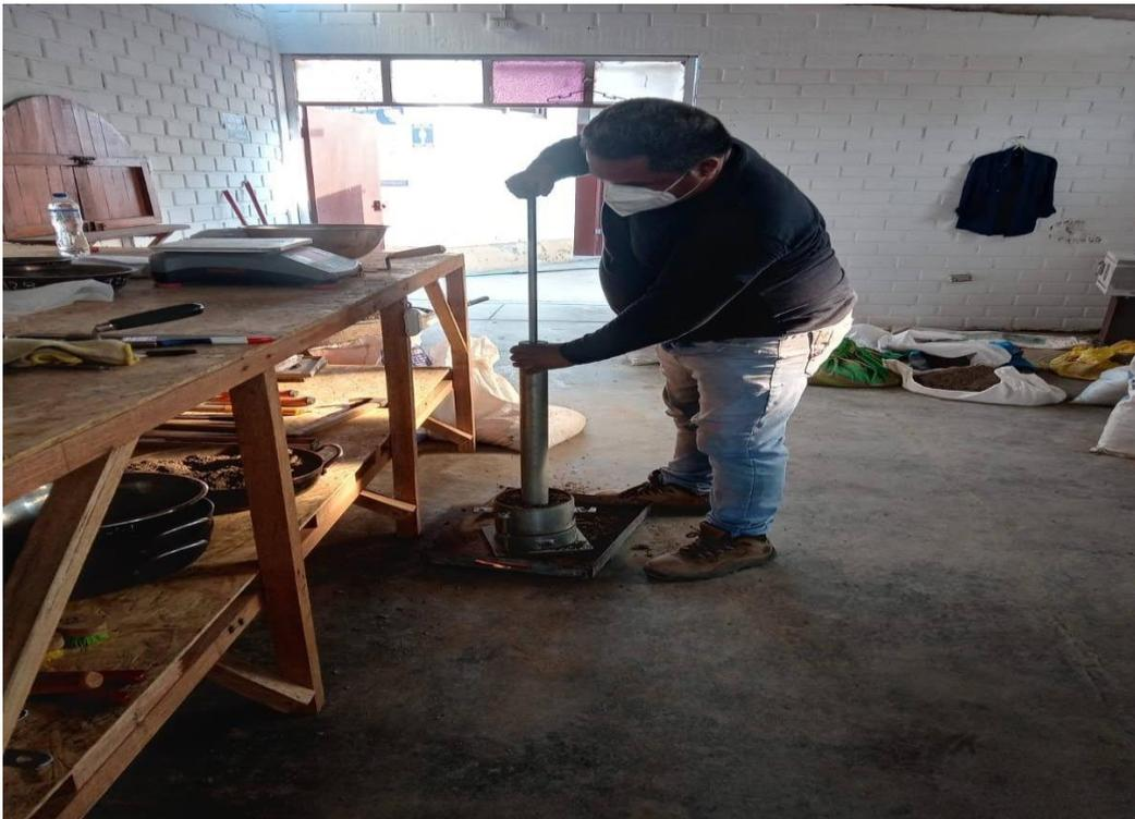
*Imagen 18.* Elaboración de Proctor Modificado muestra patrón (Ing. especialista de laboratorio)
