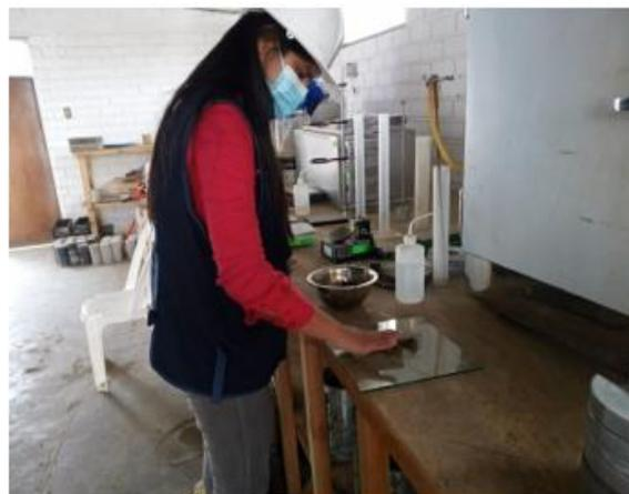
Figura 35. Ensayo de Límite Plástico del Patrón (C-2) + 4%, 7% y 11% de las CHE
