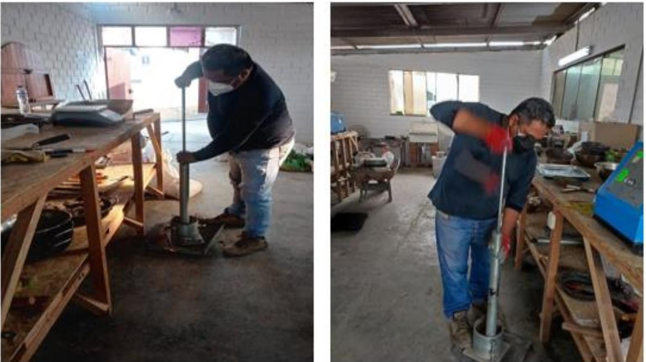
*Figura 37.* Ensayo de Proctor modificado del Patrón (C-2) + 4%, 7% y 11% de las CHE
