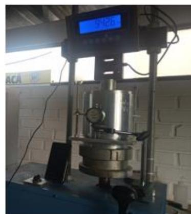
Figura 40. Instrumento de Presión de penetración para el CBR
