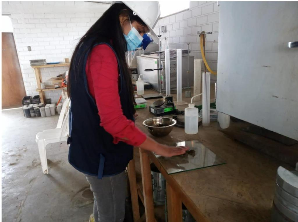
*Imagen 14.* Elaboración de muestra patrón para ensayo Limite Plástico
