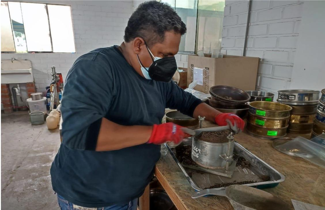
*Imagen 17.* Preparación de muestra patrón - Ensayo de Proctor modificado (Ing. especialista de laboratorio)
