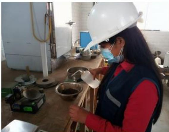
Figura 34. Ensayo de Límite Líquido del Patrón (C-2) + 4%, 7% y 11% de las CHE
