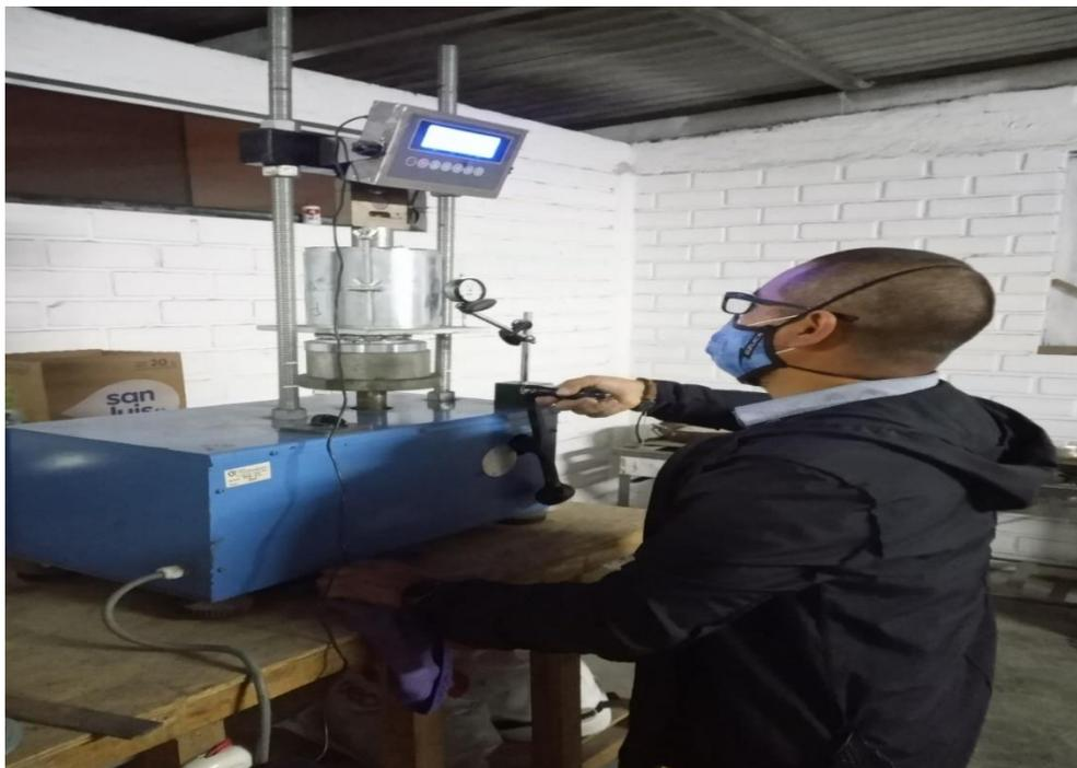
*Imagen 20. Ensayo de CBR (Ing. especialista de laboratorio)*
