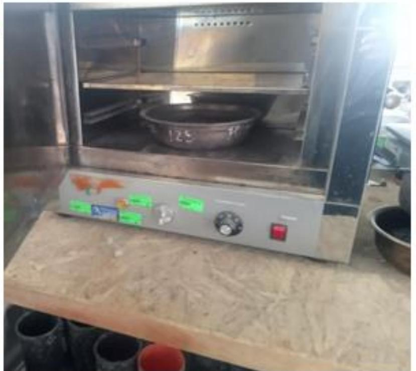
*Imagen 16. Ensayo de Proctor Modificado (secado al horno de muestra patrón)*
