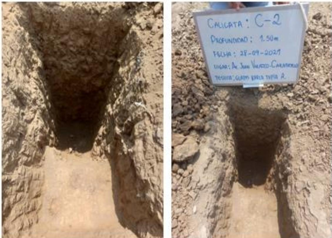
Imagen 8. Extracción de la muestra de C-2 de la Av. Juan Velazco
