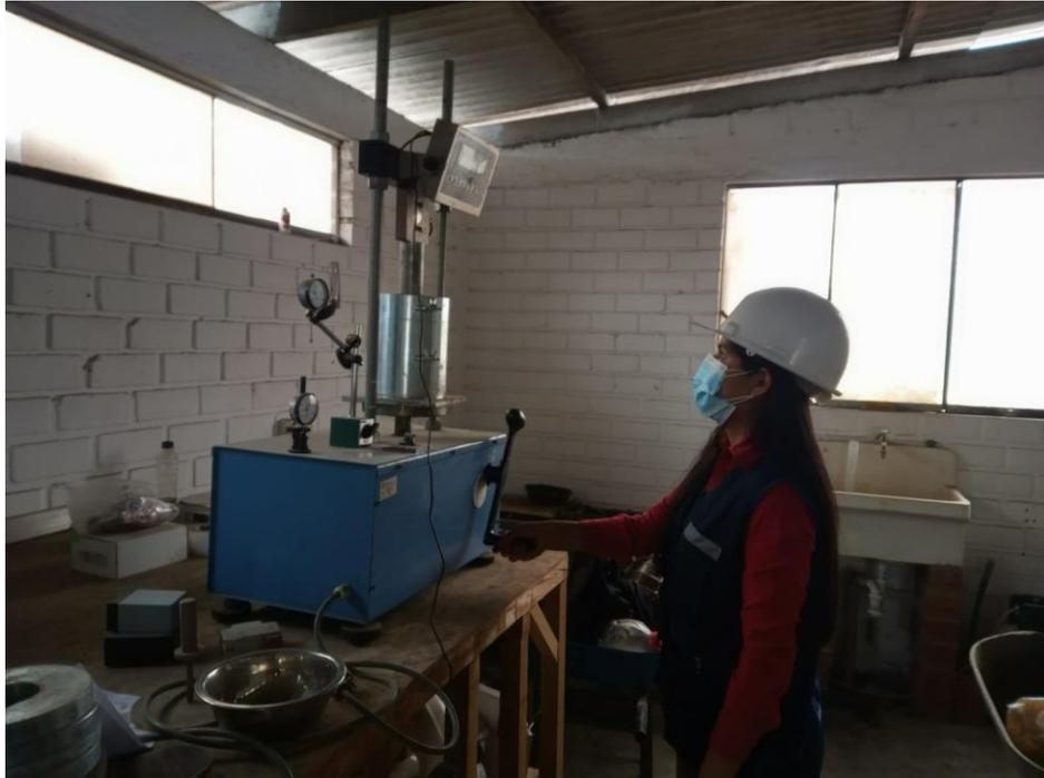
*Imagen 19. Ensayo de CBR*
