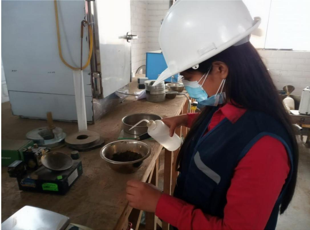
*Imagen 13.* Preparación de muestra patrón para ensayo de Limite Liquido
