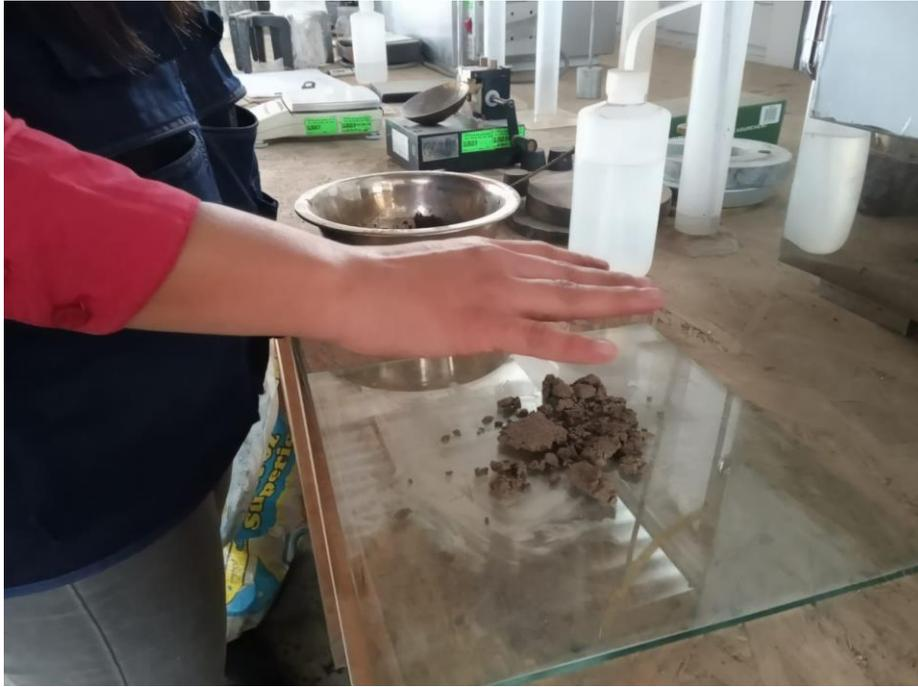
*Imagen 15. Ensayo de Limite Plástico*
