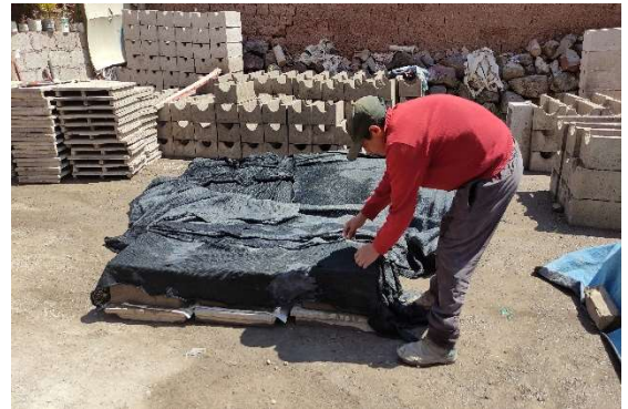
Foto. N° 24.- Proceso de curado y secado de los bloques de concreto elaborados para la presente tesis de investigación.
