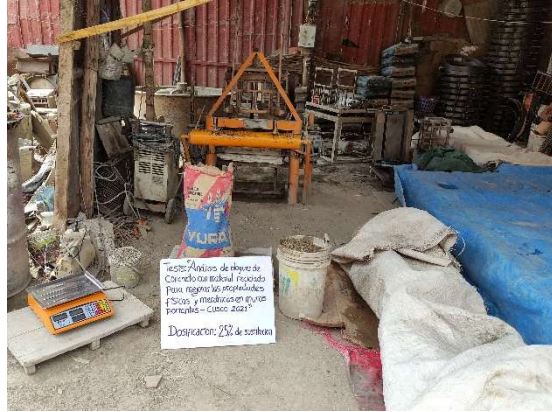
Foto. N° 17.- Toma de muestras de agregados, material reciclado – Ensayo de Humedad.
