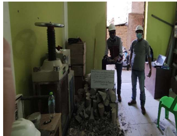
Foto. N° 04.- Laboratorio de concreto, se puede apreciar el agregado reciclado proveniente de demoliciones de edificaciones.
