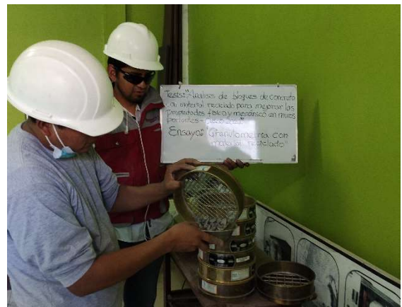
Foto. N° 08.- Granulometría del material reciclado para sus respectivas pruebas.
