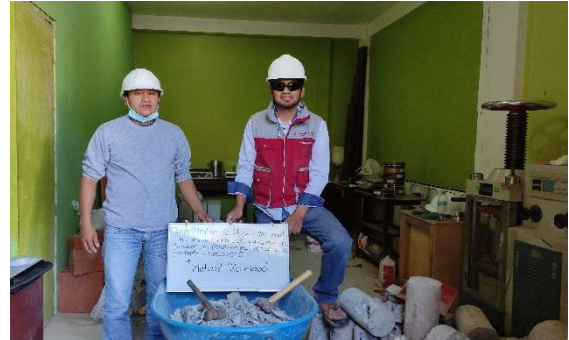
Foto. N° 06.- Material reciclado triturado de forma manual para las pruebas de laboratorio.
