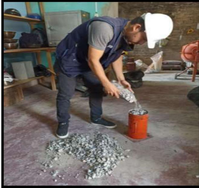
**Vista fotográfica N° 10:** Ensayo de peso específico y absorción del agregado grueso
