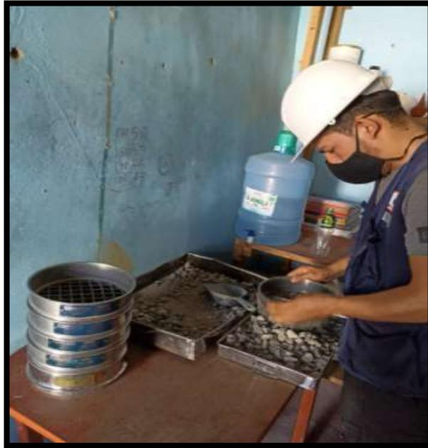
**Vista fotográfica N° 06:** Pesando lo que se retenía encada tamiz de la granulometría del agregado grueso.
