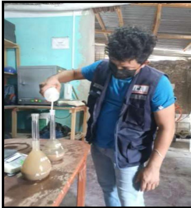
**Vista fotográfica N° 04:** Ensayo de peso unitario del agregado fino
