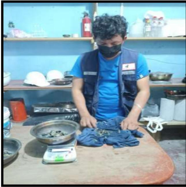
**Vista fotográfica N° 08:** Ensayo de peso específico y absorción del agregado grueso.
