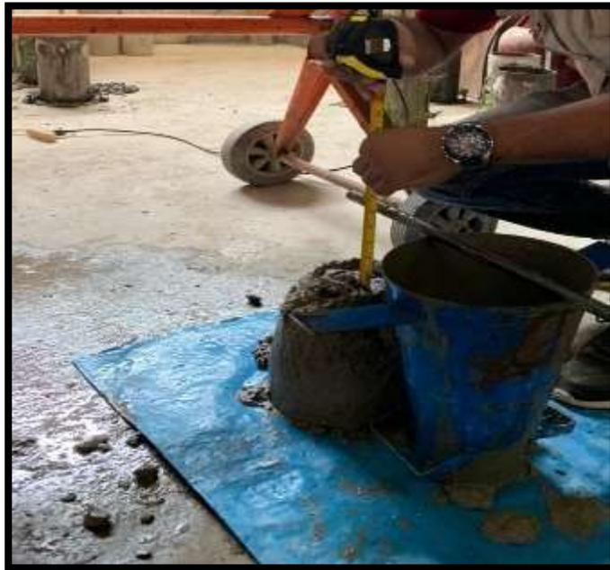
**Figura 16:** Golpeando con el martillo de goma los moldes de concreto durante el moldeado de probetas.
