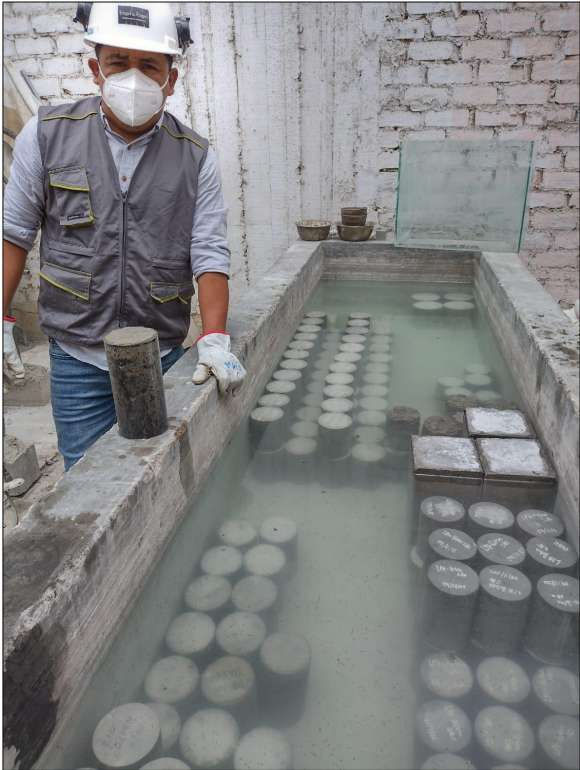
Figura 52. Los autores colocando las probetas en la poza de curado del laboratorio certificado.
