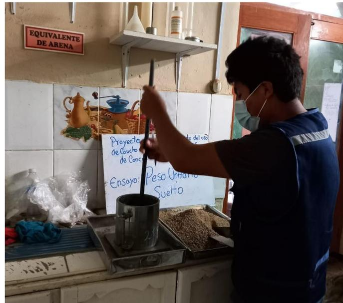
En la figura 13 y la figura 14, se muestra el trabajo realizado en laboratorio de ensayo de materiales en la ciudad de Chiclayo, determinado la densidad del material de agregado grueso en estado suelto y estado compactado.
