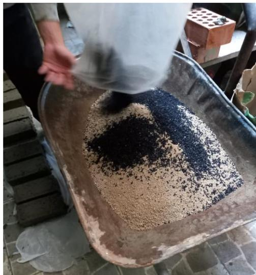
Seguidamente, después del mezclado de concreto con el caucho se procede a utilizar los moldes de metal para fabricar el adoquín solo conformado con concreto, adoquín con adición de caucho reciclado granulado en proporción en volumen de 10%, 15% y 20%.
