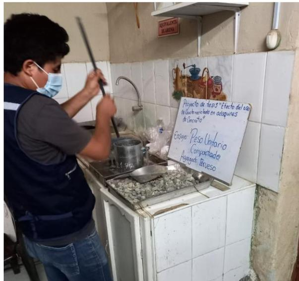
Ensayo de peso específico y absorción para el agregado grueso se determinó mediante el ASTM C 127 y el agregado fino se determinó mediante el ASTM C 128.
