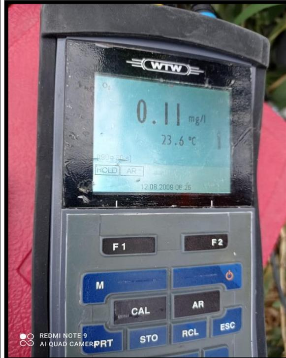
Figura 10. Toma de muestra del canal La Cachaza, de resultados de la medición sobre el oxígeno disuelto.
