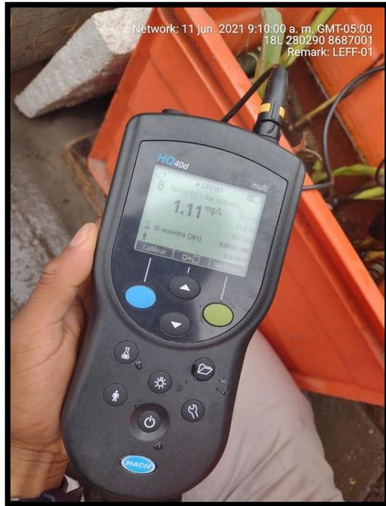
Figura 18. Obtención de la medición del oxígeno disuelto en la isla flotante.
