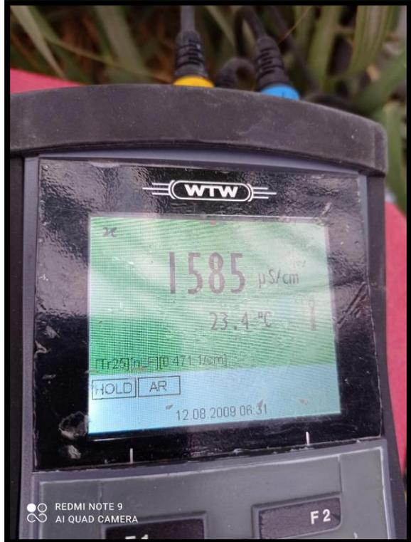
Figura 12. Toma de muestra del canal La Cachaza, de resultados de la medición sobre conductividad.
