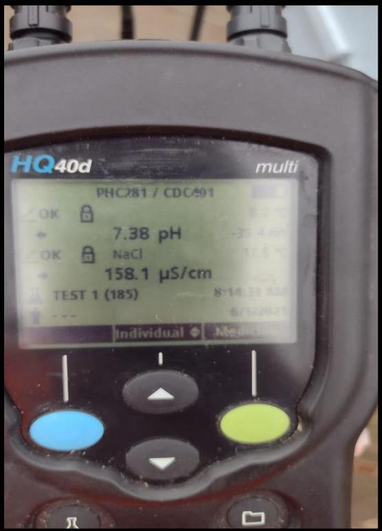
Figura 14. Medición en campo del Ph y la conductividad en la isla flotante.
