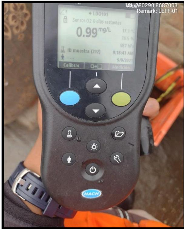
Figura 15. Medición de la muestra en la isla flotante, de oxígeno disuelto.
