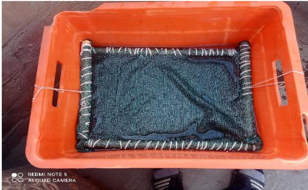
Figura 5. Muestra de agua con la isla flotante realizado con malla raschel y caña.
