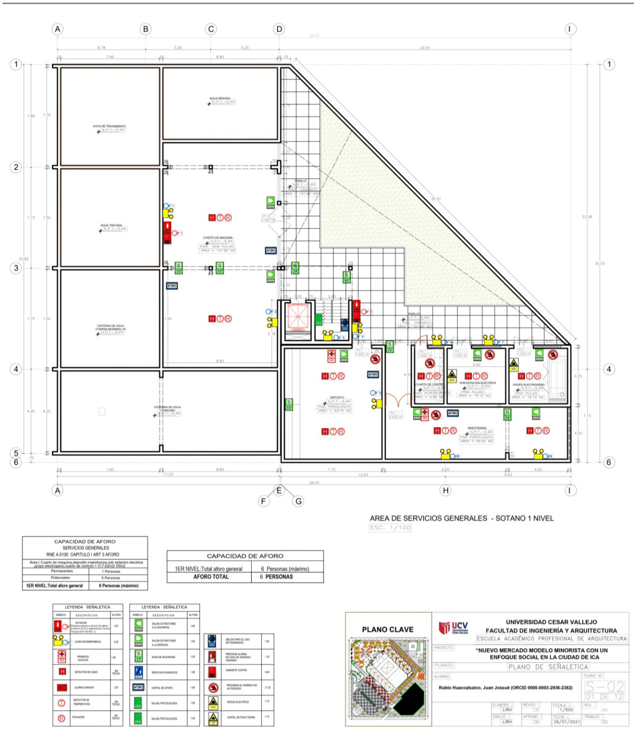
figura 42: Plano de Señalética - sótano 1er nivel
