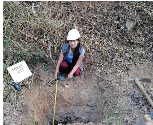
*Figura 8.* Extracción del material de la Calicata N° 02.
