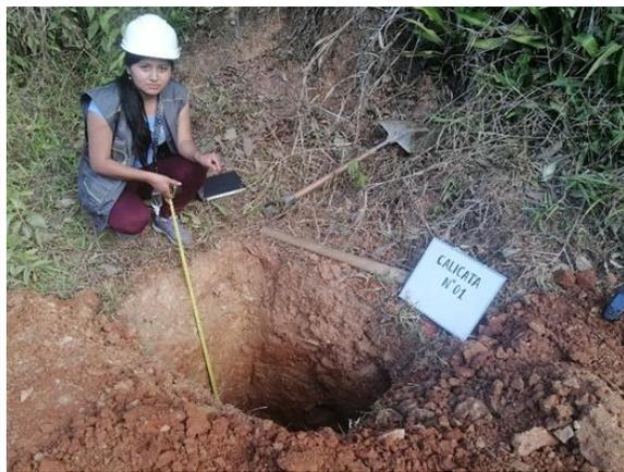
*Figura 7.* Extracción de material de la calicata N° 01.
