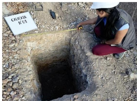
*Figura 09.* Extracción de material de la calicata N° 03.
