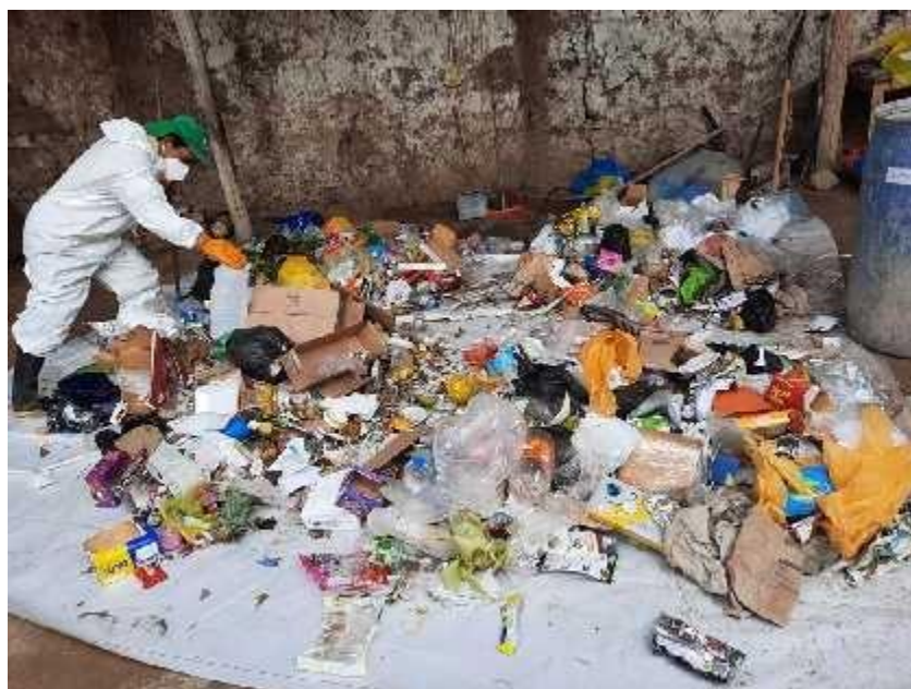
Foto 4: Clasificación de residuos sólidos, método de cuarteo.
