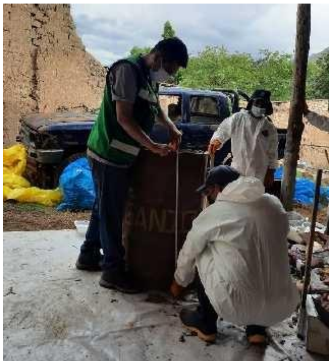
Foto 5: Toma de medidas del cilindro para determinación de la densidad.
