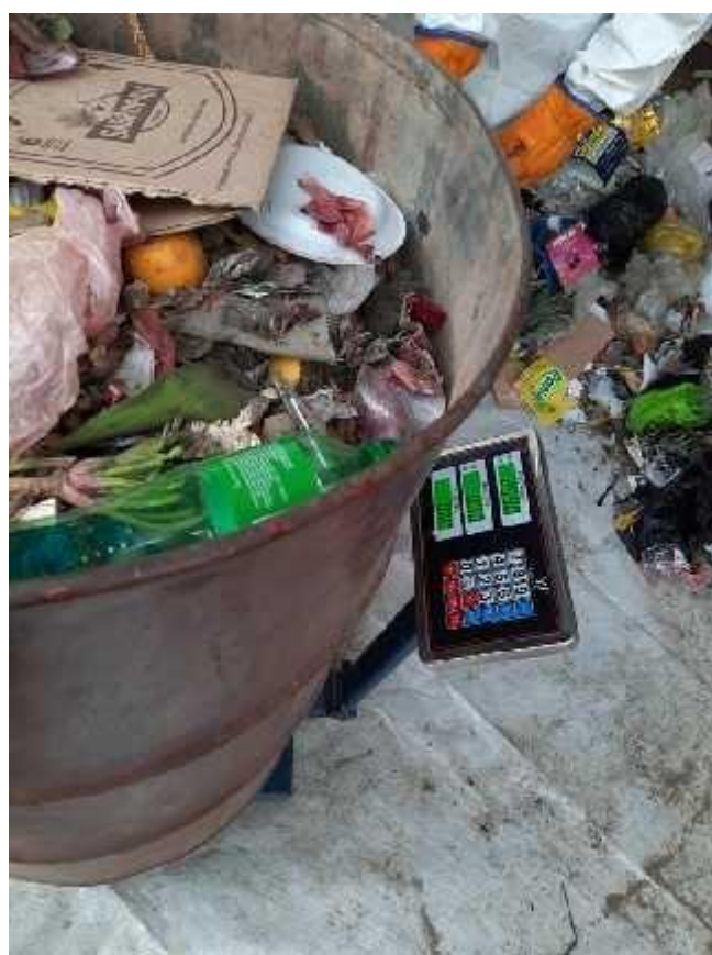
Foto 6: Pesaje de residuos sólidos para determinar la densidad.
