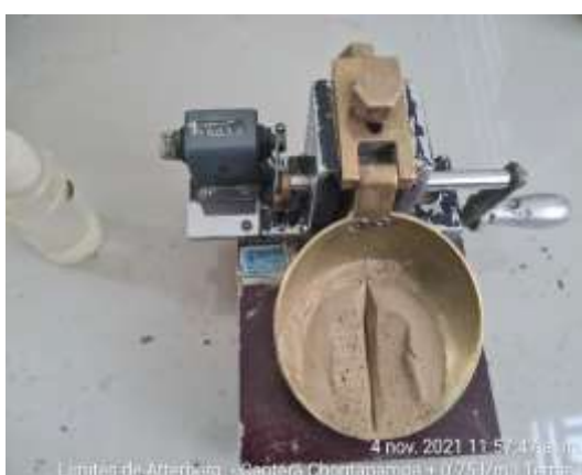
Figura 9. Adición del Aditivo Terrasil de 0.75 lt/m 3
