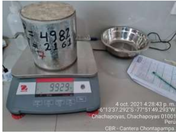
Foto 10. Pesado de Molde para el ensayo del CBR
