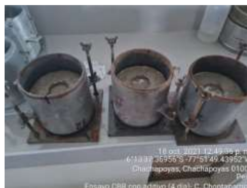
Figura 13. Moldes de CBR con dosificaciones de Aditivo Terrasil.
