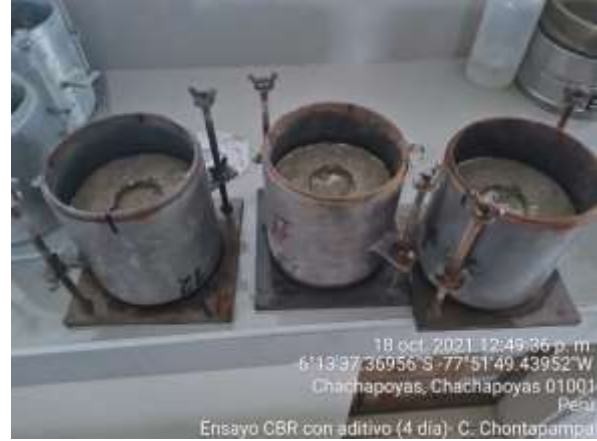
Foto 6. Moldes del ensayo del CBR con el Aditivo
