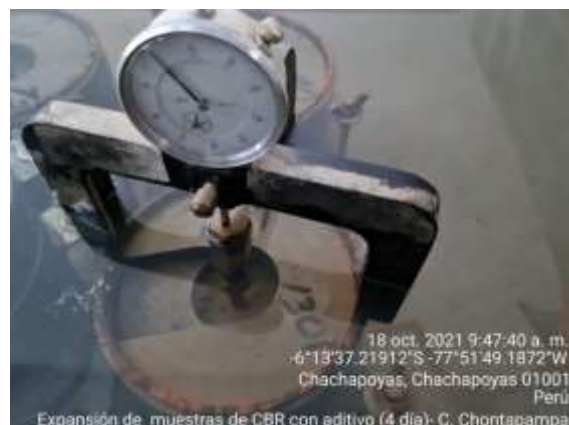
Figura 16. Expansion con 0.75 lt/m3 de Aditivo Terrasil
