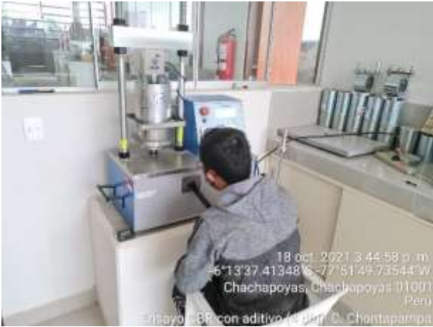
Foto 5. Prueba de ensayo de CBR con el Aditivo
