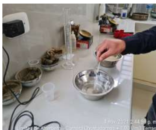
Figura 10. Limite Líquido con adición de 1.00 l/m 3 Aditivo Terrasil
