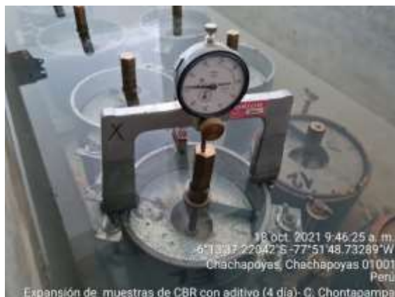
Figura 15. Expansion con 1.5 lt/m3 de Aditivo Terrasil.
