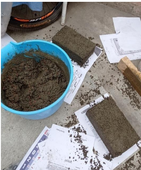
Figura 15: Mezcla de cemento, arena y agua mas PET
