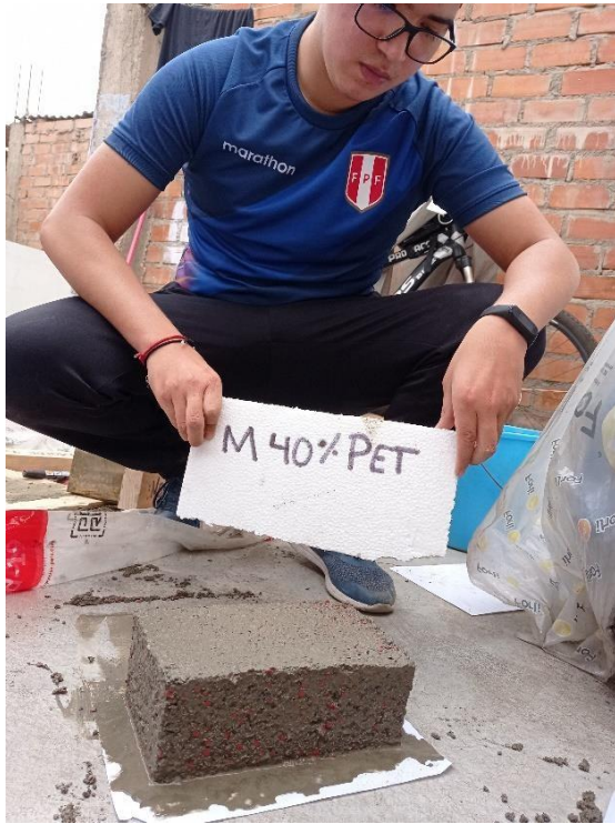
Realización de ladrillo de concreto con PET
