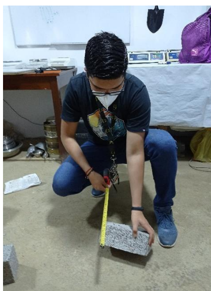
Figura 22: Medición de ladrillo con agregado PET
