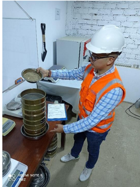
Ensayo de tamizado del agregado
