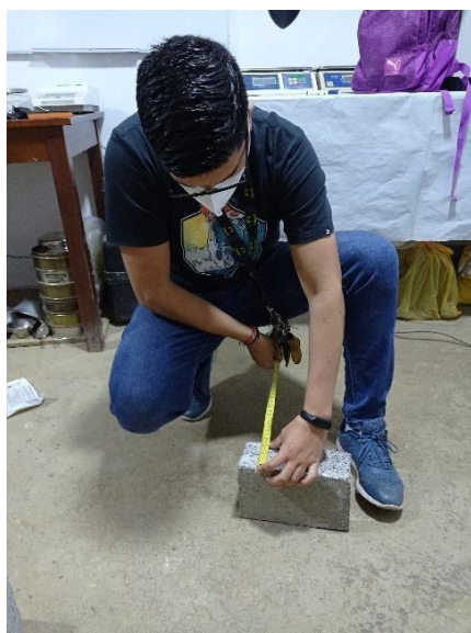
Figura 21: Medición de ladrillo con agregado PET
