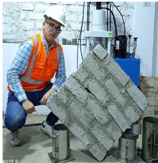
Figura 19: Ensayo de murete
