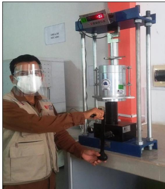
**Fotografía 02.** Realización de Ensayo de CBR a las muestras con adición de ceniza de madera.
