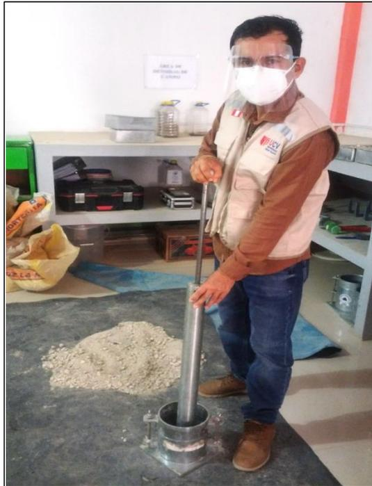
**Fotografía 03.** Realización de Ensayo de Proctor modificado a las muestras con adición de ceniza de cáscara de arroz y madera.
