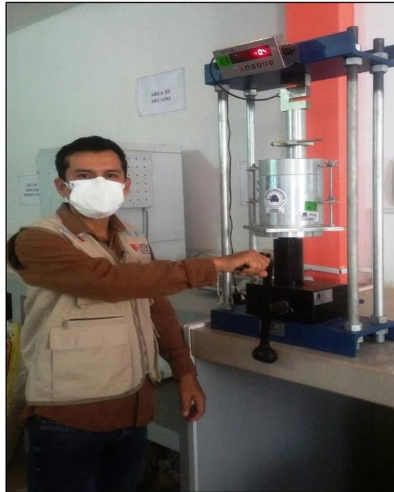
**Fotografía 01.** Realización de Ensayo de CBR a las muestras con incorporación de ceniza de cáscara de arroz.
