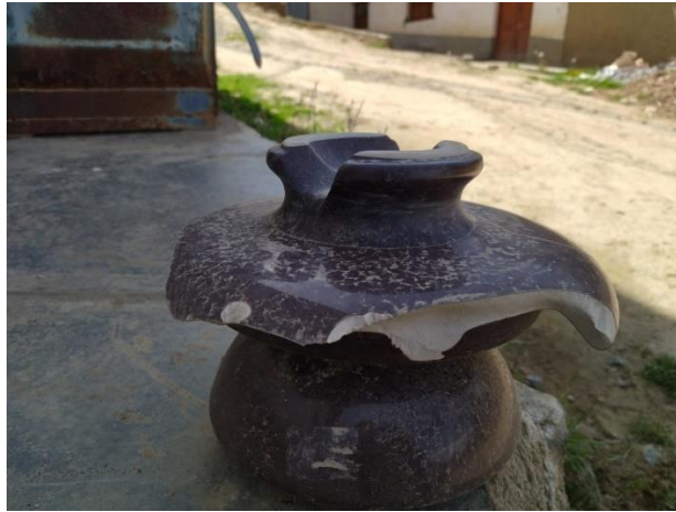
Figura 8: Aislador polimérico roto.
