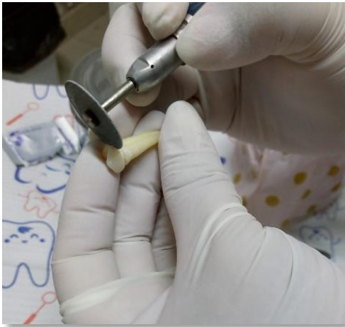
Figura 2: Corte de los dientes con disco diamantado
