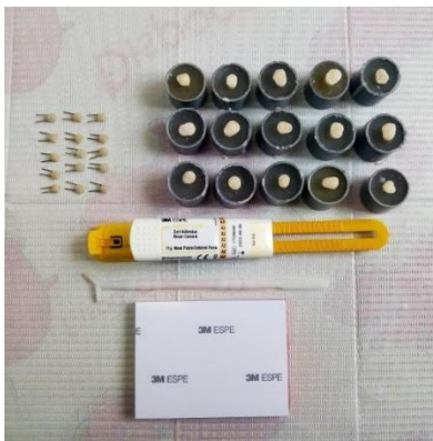
Figura 11 : Materiales y procedimiento de adhesión con Single Bond Universal 3M de las muestras
