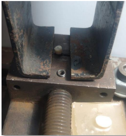
Figura 19: Prueba de tracción con la máquina de ensayo universal CMT-5L
