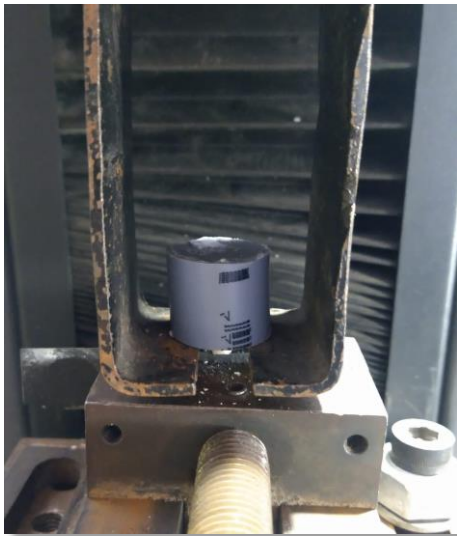
Figura 19: Prueba de tracción con la máquina de ensayo universal CMT-5L
