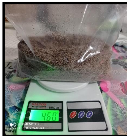
Figura N° 7: Molienda y pesado de los residuos de la castaña.
