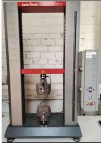
Figura N° 35: Análisis de tracción de los bioplásticos.
