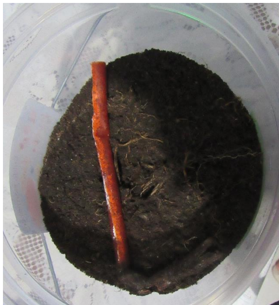
Figura N° 32: Inicio de biodegradación de los sorbetes de Bertholletia excelsa .
