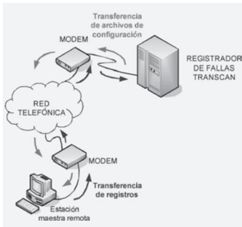
Figura 13 Modelo de comunicación por Red Telefónica. Fuente: Bustinza Macedo, 2008.
