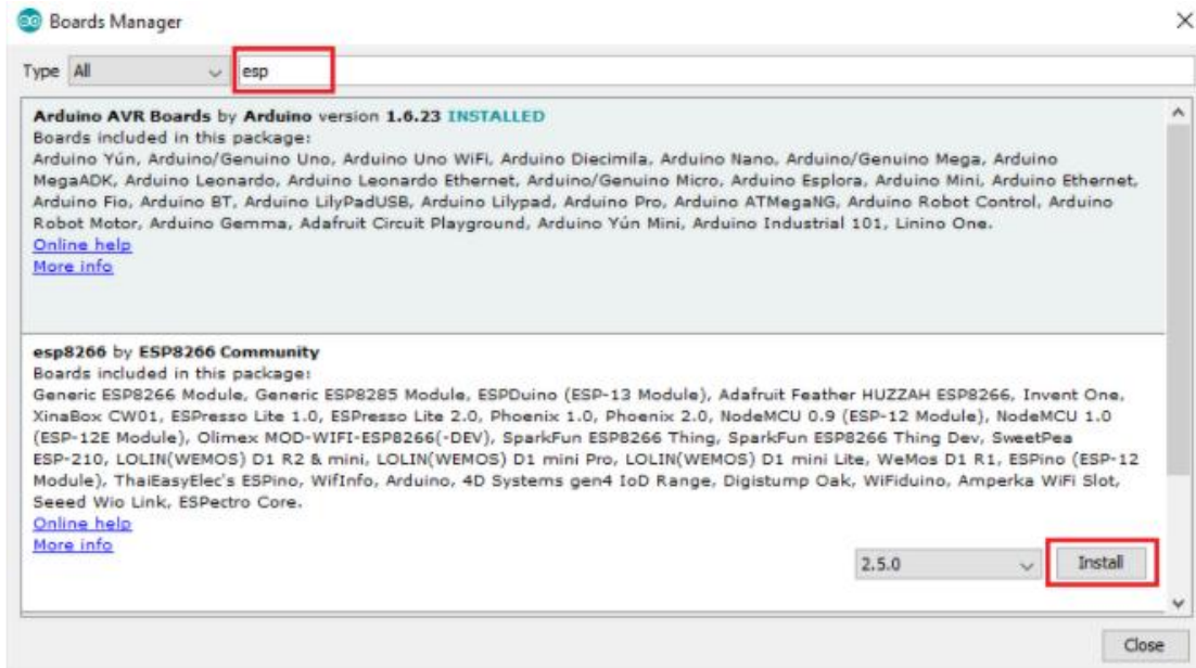
Figura 72 Paso 4 – Configuración para ESP-01
