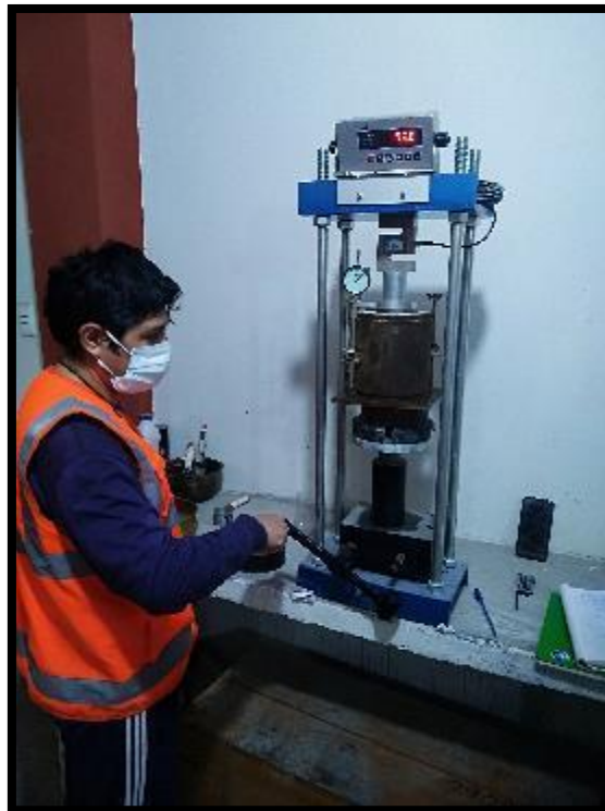
Figura 12. Realizando la prueba de CBR.
