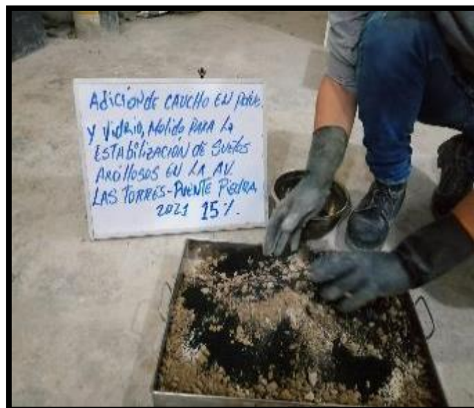
Figura 15. Mesclado del caucho y vidrio con el suelo natural para efectuar las dosificaciones.
