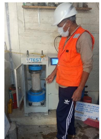
Foto 09.- Ensayo de la resistencia a la compresión de los especímenes.
