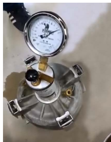
Foto 08.- Ensayo de Contenido de Vacíos de la muestra.
