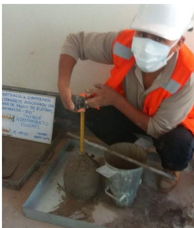
Foto 07.- Ensayo del asentamiento de la muestra (slump)
