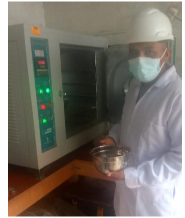
Foto 03.- Colocado de la muestra al horno a 110 °C
