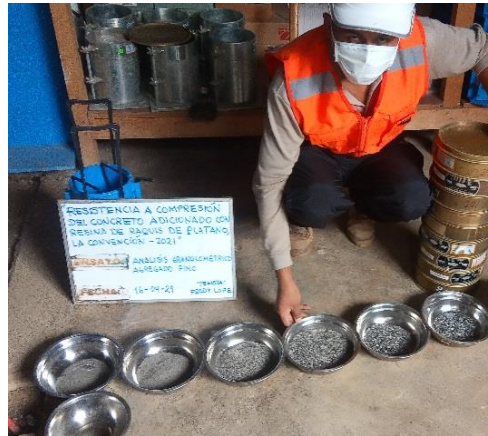
Foto 02.- Análisis Granulométricos de los agregados grueso y fino.
