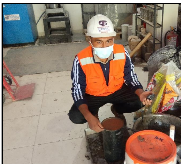
Figura 25: Ensayo de la exudación de la mezcla de concreto
