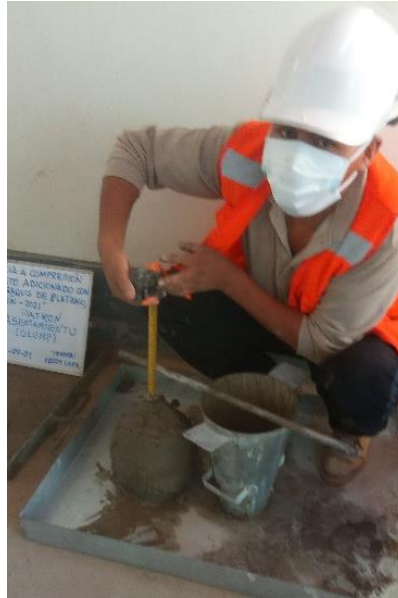
Figura 26: Ensayo del slump de la mezcla fresca
