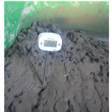
Foto 06.- Medición de Temperatura de la muestra.
