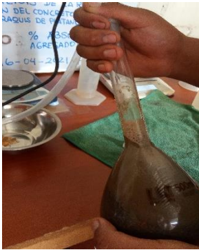
Foto 04.- Eliminación de Vacíos del picnómetro.
