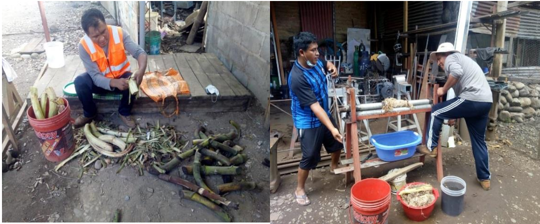
Figura 17: Proceso de extracción de la resina de raquis de plátano.
