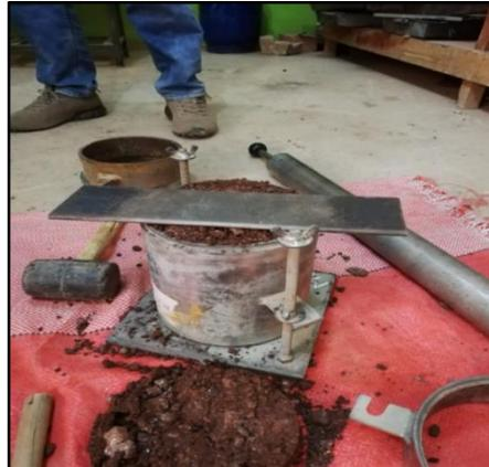
*Figura 35. Perfilamiento de la Muestra*
