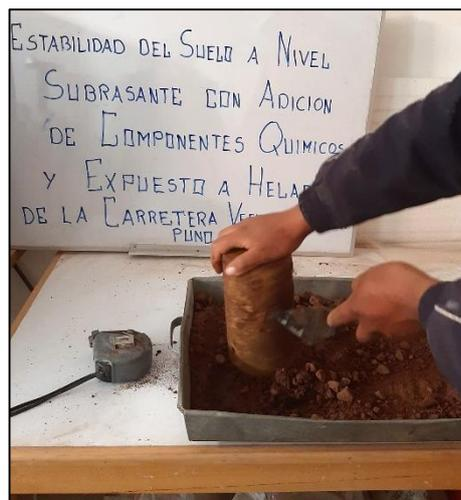
*Figura 46. Moldeando en Cilindros.*
