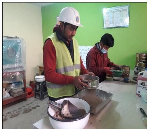
Figura 10. Tamizado Mecánico en dos Series la Fracción Fina y la Gruesa
