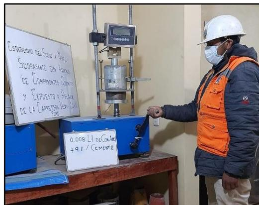
Figura 38. Penetración del Molde
