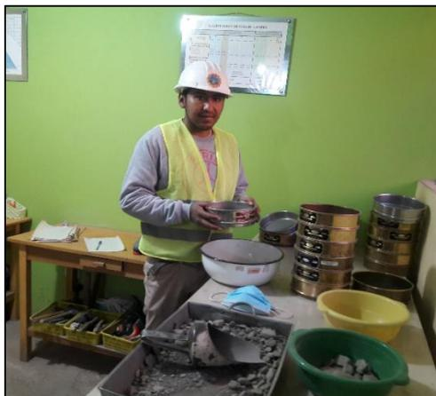
Figura 22. Tamizado a través de las mallas N°04, 3/8" y ¾".
