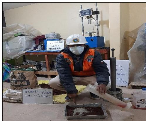
*Figura 32.* Incorporación de Humedad Óptima
