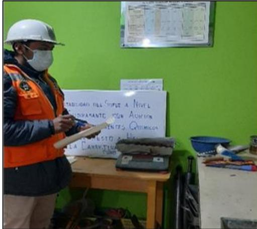
Figura 11. Pesado de las Fracciones Retenidas en las Respectivas Mallas, Toma de datos. Se observa en la siguiente tabla 6 los datos del resultado.
