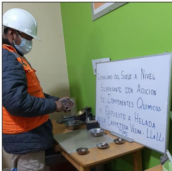
Figura 16. Fracción de la Mezcla en la Cuchara y Nivelando la Maza con la Espátula
