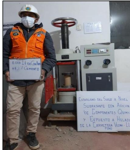
Figura 50. Muestra Puesta en Máquina de Compresión
