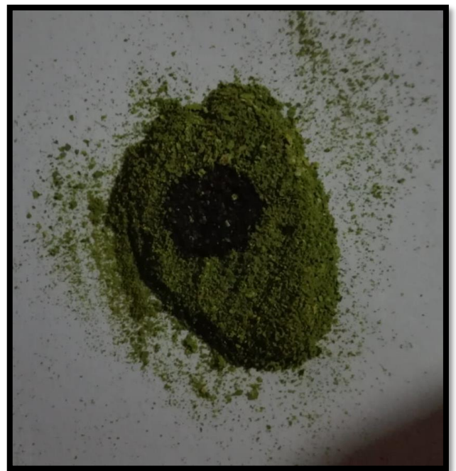
Prueba de lugol, presencia de almidón.
