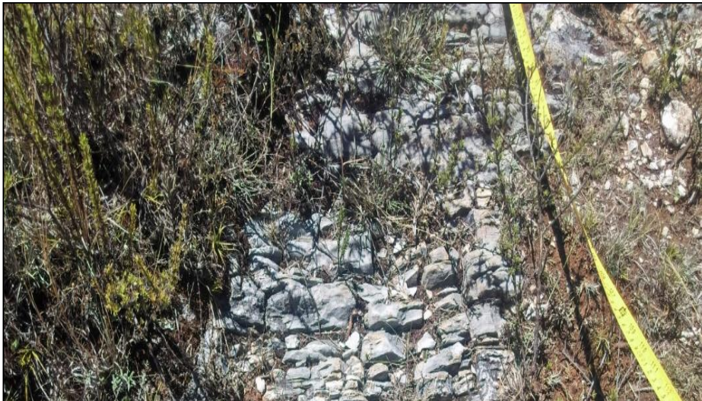
Figura 16. Estructura laminar, presentes en estratos de calizas de la formación Cajamarca.
