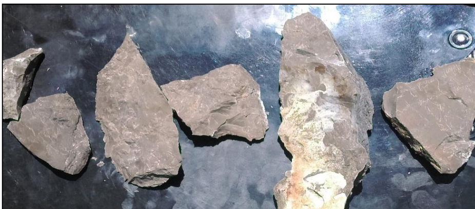
Figura 19. Calizas mudstone, las muestras de las calizas de la formación Cajamarca muestran una coloración gris azulina que es una característica notable de esta formación.
