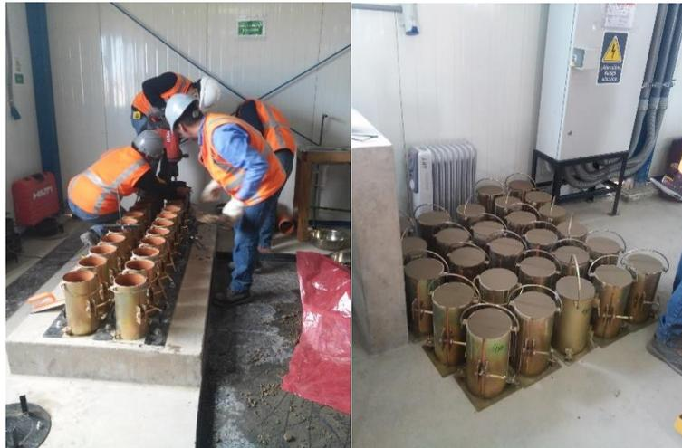
Elaboración de probetas de concreto CCR
