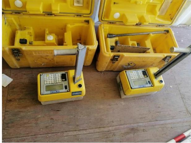
Densímetro nuclear de una sonda de marca Troxler 3440 Plus.
