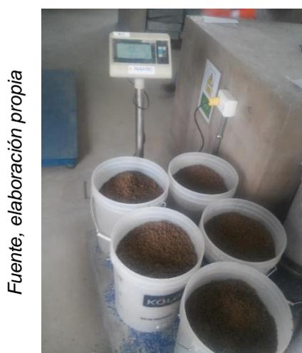
Peso de los agregados para CCR en estado SSS
