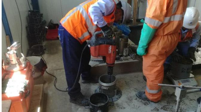
Ensayo para obtener el peso unitario y contenido de aire en la mezcla
