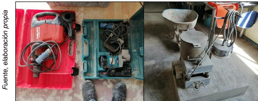
*Equipo vibro compactado y mesa vibratoria VeBe*
