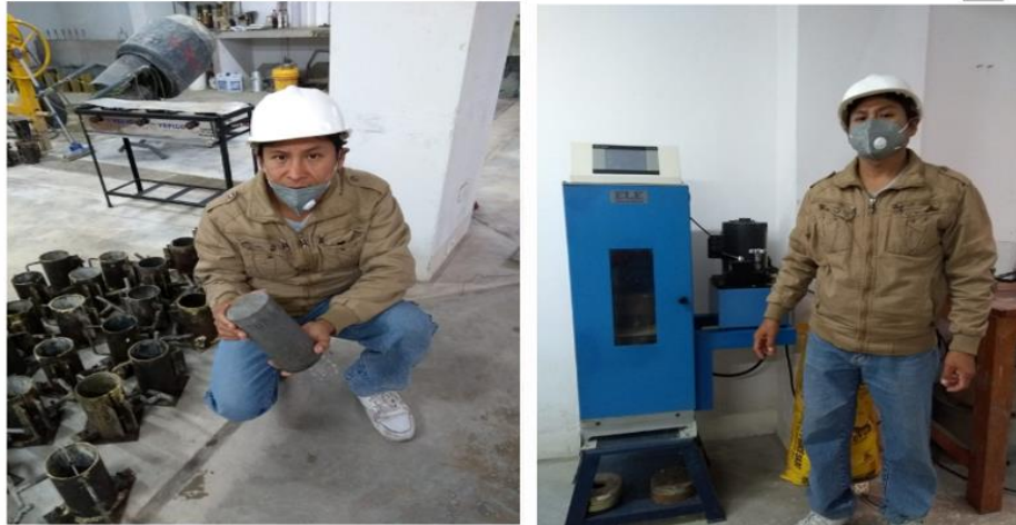
Figura 5. Ensayo de probeta y ensayo a la compresión
