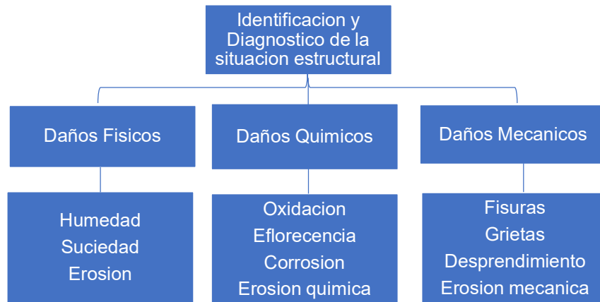
Figura 4. Procedimiento del diagnóstico e identificación de las patologías.
