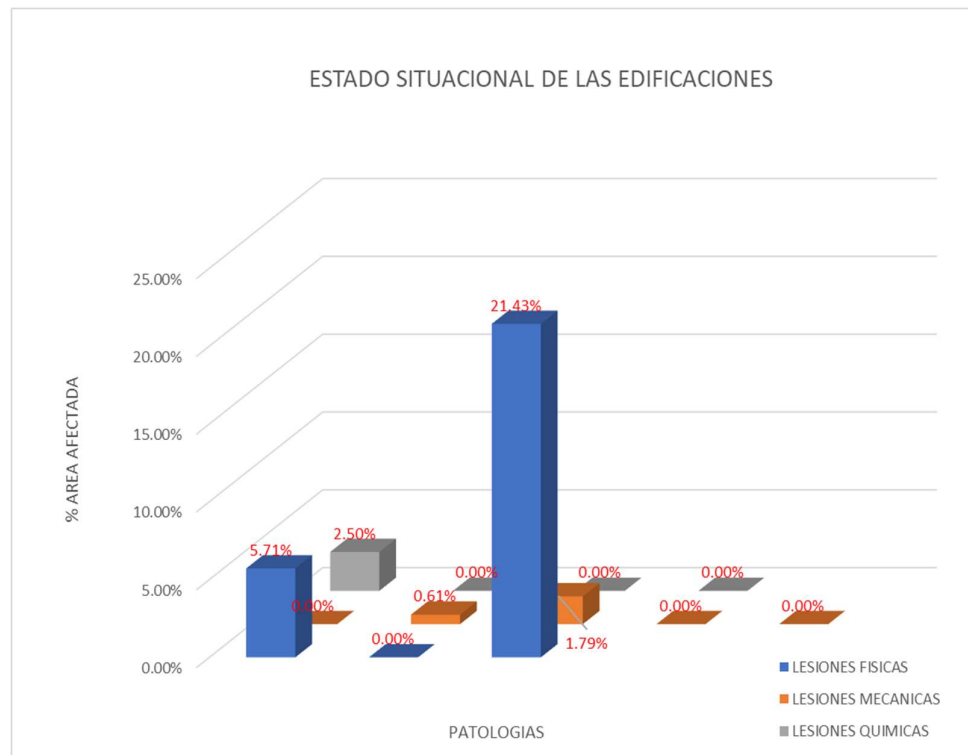
Figura 10. Resultado de Evaluación de la edificación autoconstruida seleccionada.
