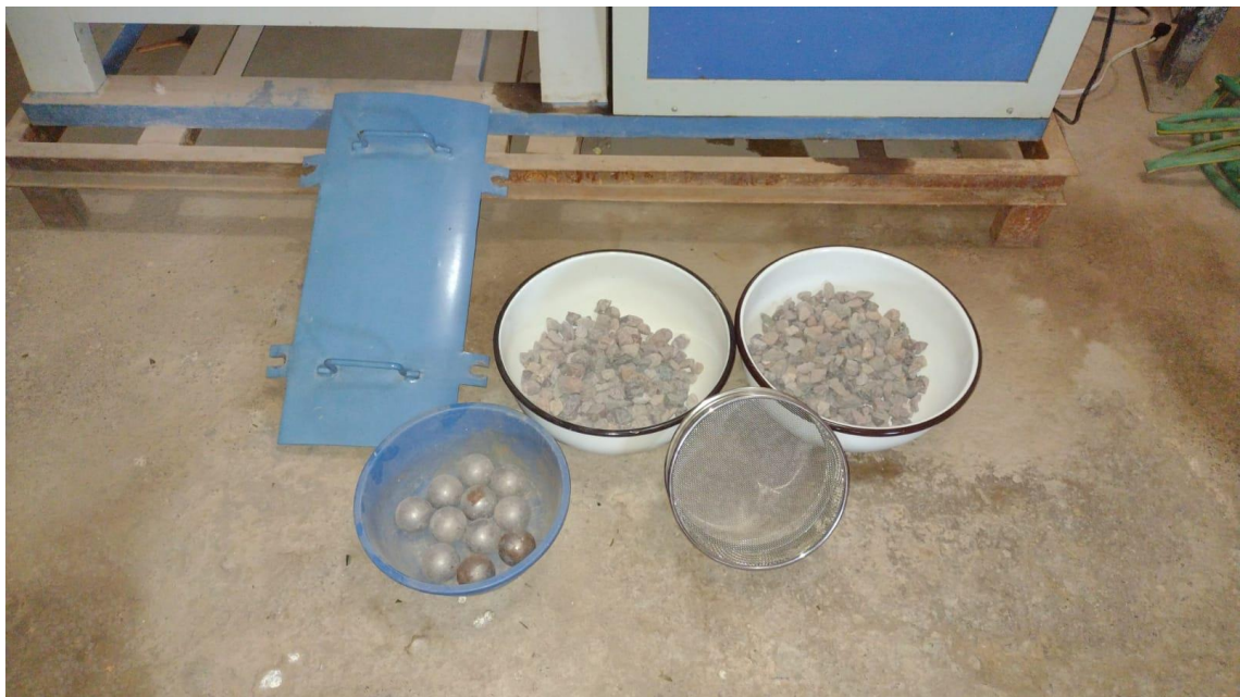
Imagen N° 0 10 Muestra para determinar el ensayo de Abrasión los Ángeles.
