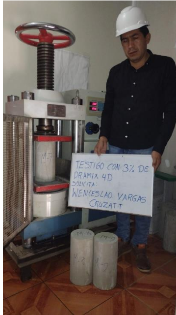
Imagen N° 0 15 Ensayos de Compresión Simple en testigos con 3% de Dramix 4d.
