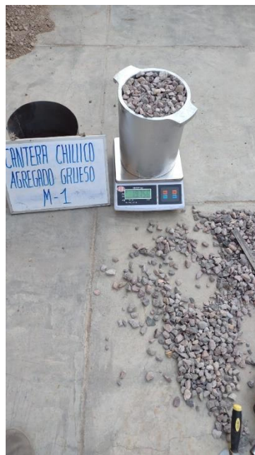
Imagen N° 0 6 Ensayo de Peso unitario de agregado grueso.
