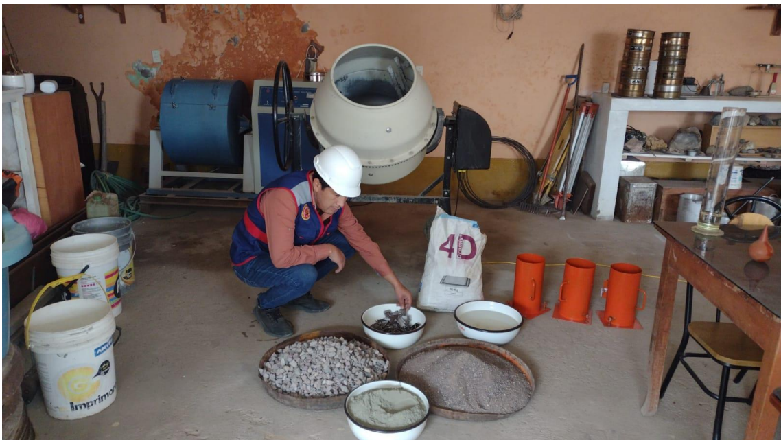
Imagen N° 0 12 Materiales para la elaboración de Probetas y Vigas (Cemento, Piedra Chancada, Arena Zarandeada, Dramix 4D y Agua).
