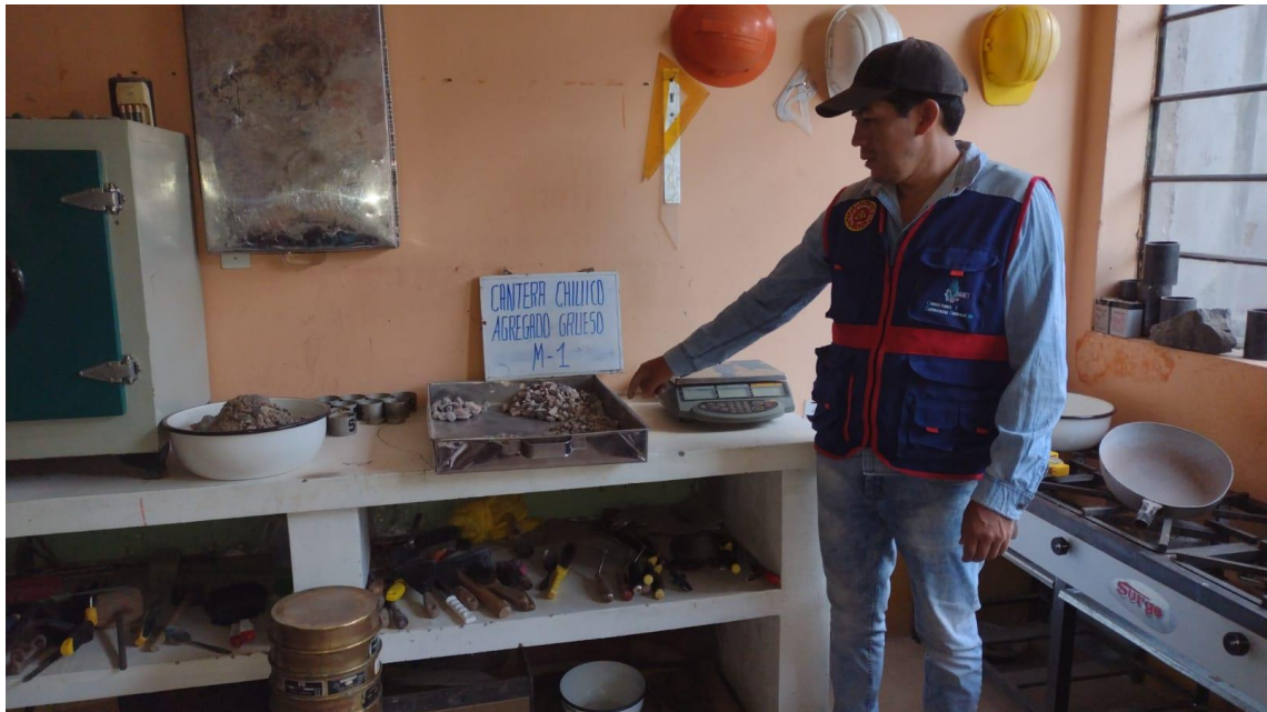
Imagen N° 0 9 Análisis granulométrico del Agregado Grueso (Piedra Chancada).
