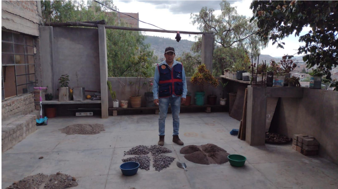
Imagen N° 0 5 Procesamiento de Muestras en Laboratorio del Agregado Grueso y Fino (Obtención de muestras representativas-Cuarteo).
