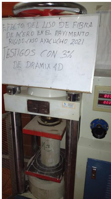
Imagen N° 0 16 Realizando ensayos de resistencia a la compresión simple de los concretos.
