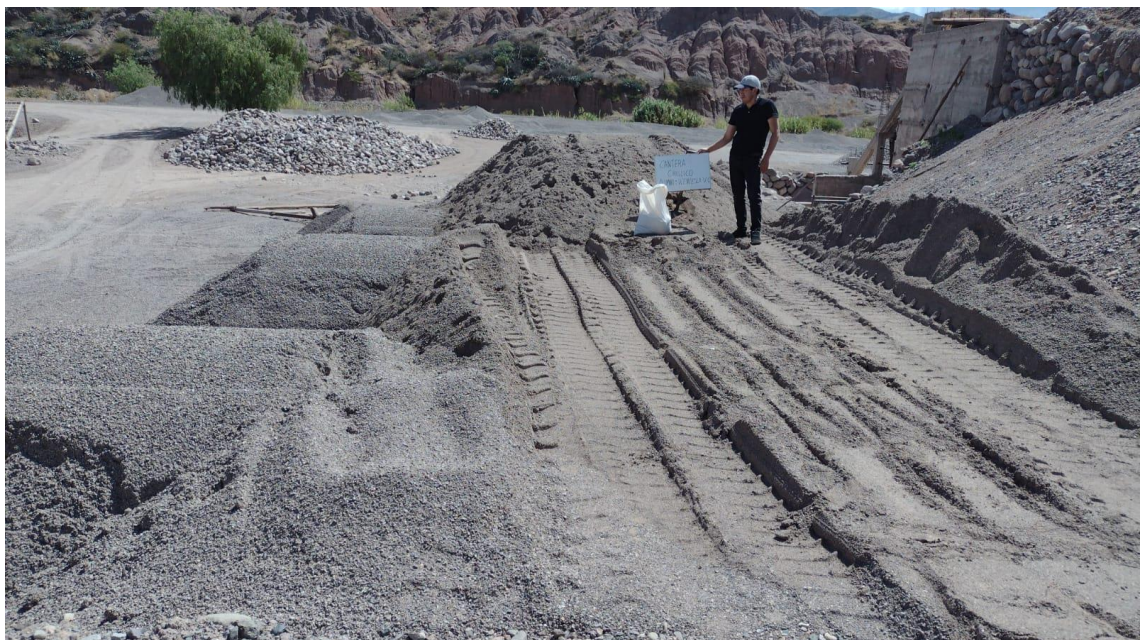
Imagen N° 0 4 Recojo de la muestra de Agregado Fino (Arena Zarandeada) de la Cantera Chillico.
