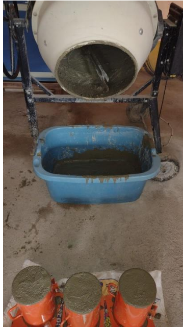
Imagen N° 0 13 Elaboración de Probetas de Concreto.
