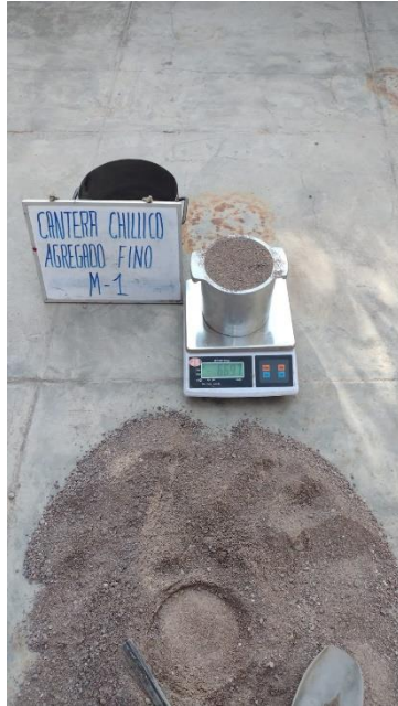
Imagen N° 0 7 Ensayo de Peso unitario de Agregado Fino.
