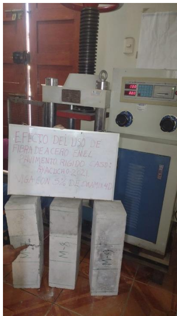
Imagen N° 0 18 Vigas después de los ensayos de flexión en las vigas.
