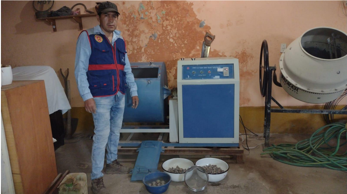
Imagen N° 0 11 Ensayo de abrasión de los ángeles.
