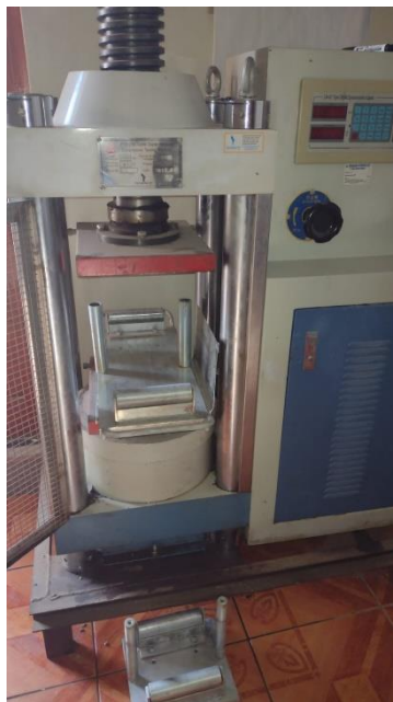
Imagen N° 0 14 Equipo para realizar los ensayos de resistencia a Flexión en las Vigas.
