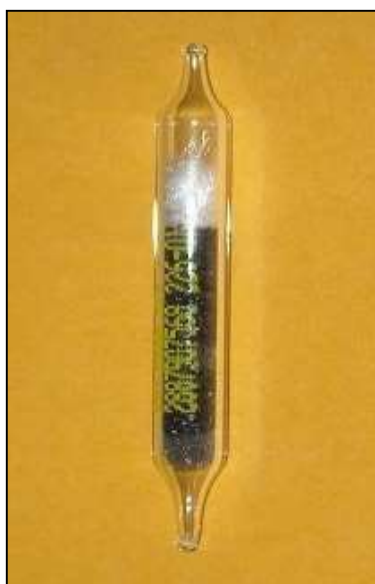
Figura 8: Tubo Orbo de absorción (Benceno)
