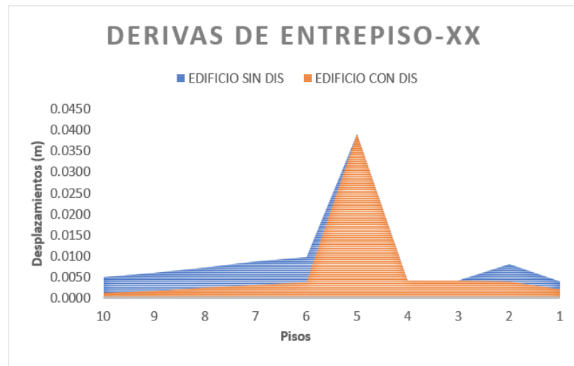
Figura 21: Derivas de entrepiso - Dirección "X".
