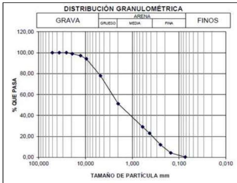
Figura 3: Representación gráfica de la curva granulométrica, tomada de “Evaluación y comparación del análisis granulométrico obtenidos de agregados naturales y reciclados”.
