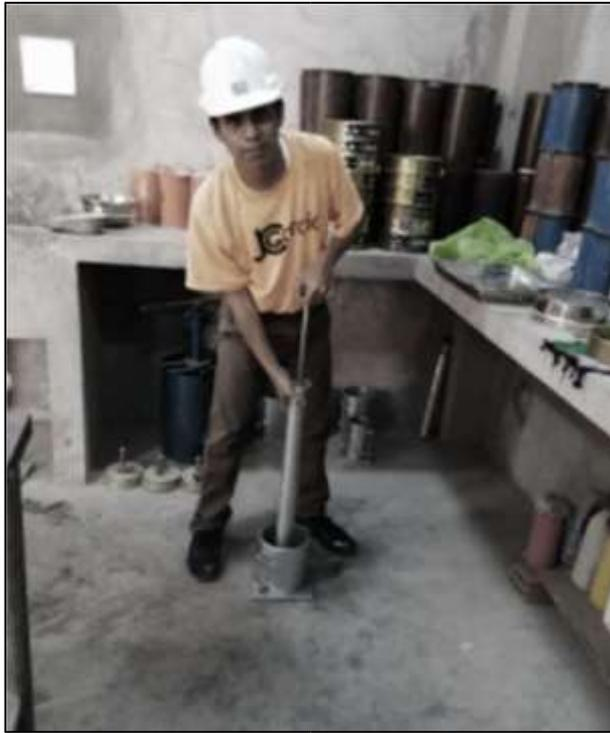
Figura 16: Ensayo de CBR.
