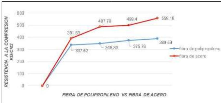
Figura 20: Comparativa entre las resistencias de los adoquines de concreto de fibra acero con los adoquines de concreta fibra de polipropileno
