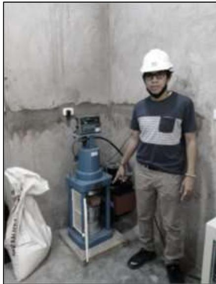
Figura 13: Ensayo de compresin, adoquines de concreto con fibras de acero.
