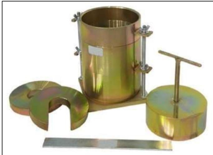
Figura 8: Accesorios y molde del CBR, tomada de “cotecno.cl”
